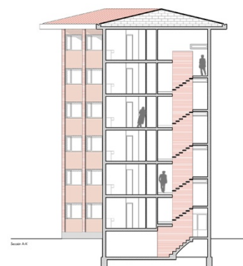
Sección por núcleo de escaleras
