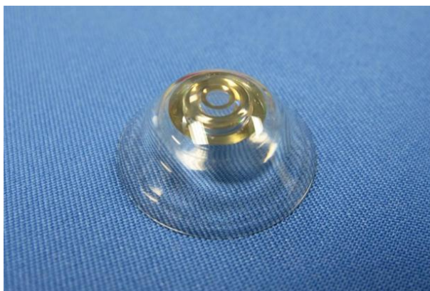
7-1 Lentes de contacto que permiten cambiar entre vista normal y telescópica guiñando un ojo (Investigadores del Instituto Federal Suizo de Tecnología en Lausana, Suiza)
