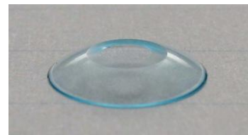
4-3 LCRPG semiterminada con el orificio de 3,0 mm en su zona central. . (Tesis doctoral de la Dra. Irene Sanchez Pavón)
