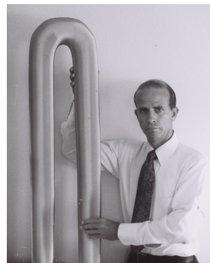
(b) : lingote de silicio grado metalurgico, cortesía de Polycrystalline Silicon Technology Corporation (P.S.T.)
