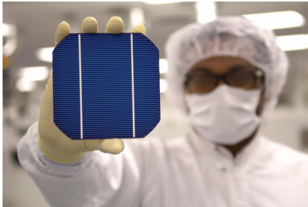
Figura 2.2 : célula solar fotovoltaica monocristalina, cortesía de Spectrolab
