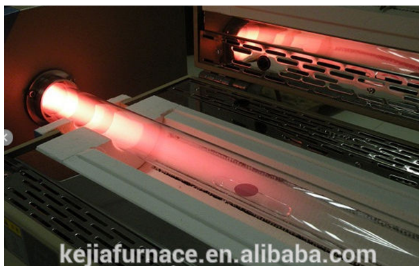
Figura 2.8 : horno de deposición de a-Si:H, cortesía de Keija Furnaces (fotografía de https://www.alibaba.com/ )
