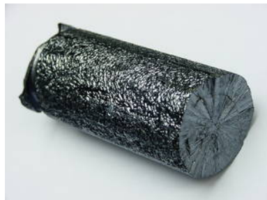
(a) : lingote de silicio grado metalurgico, cortesía de Warut Roonguthai
