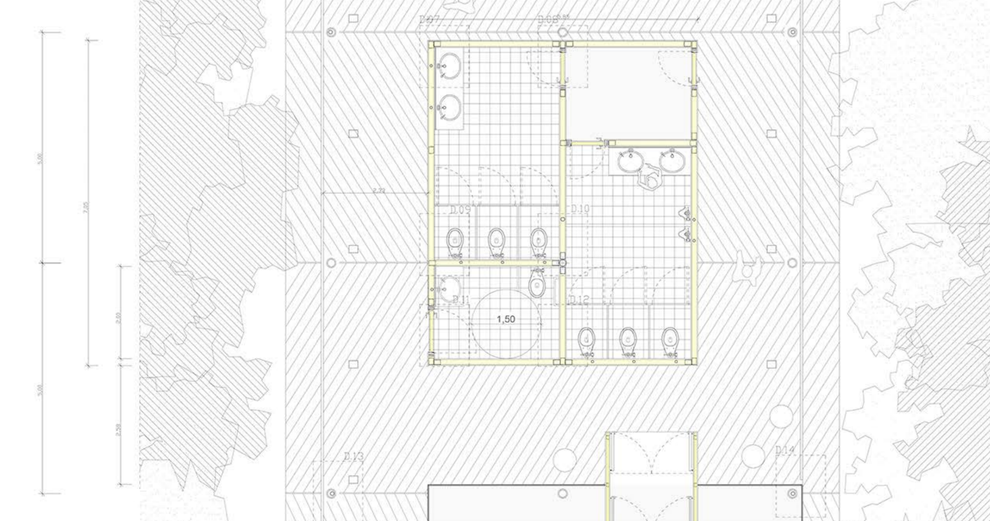
SECCIÓN HORIZONTAL SERVICIOS E 1:50
