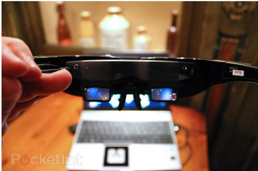
Figura 33.- Muestra de las pantallas LCD del HMD Vuzix Wrap 920AR [21]
