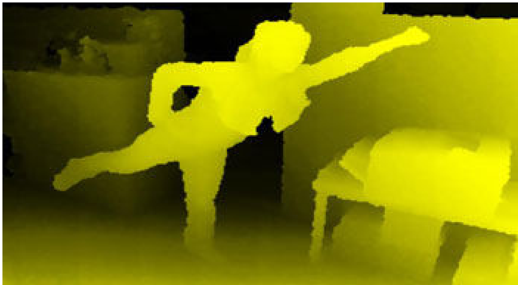
Figura 5.4: Detección del cuerpo completo por Xtion.
