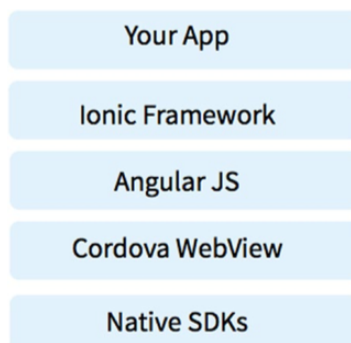
Ilustración 22: Arquitectura en forma de pila
