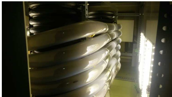
Figura 4: Biorreactor tubular experimental. Departamento de Ingeniería Química y Tecnología del Medio Ambiente de la Universidad de Valladolid
