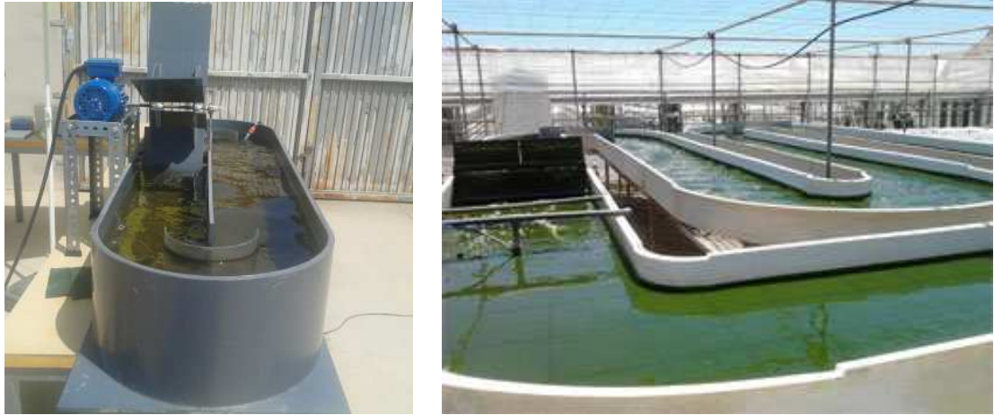
Figura 3: Bioreactores tipo Raceway (izquierda) y capa fina (derecha). Departamento de Ingeniería Química. Universidad de Almería.
