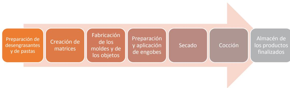
Ilustración 17 - Proceso de fabricación de artefactos sonoros cerámicos. Esquema Juan Manuel Bejarano.
