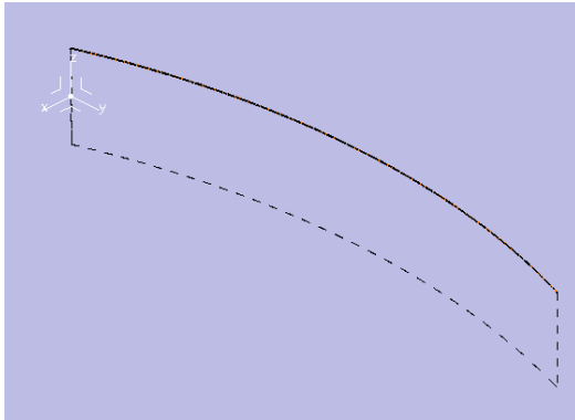
Figura 3. 6: Perfil de la vela a \alpha=90^\circ en Catia
