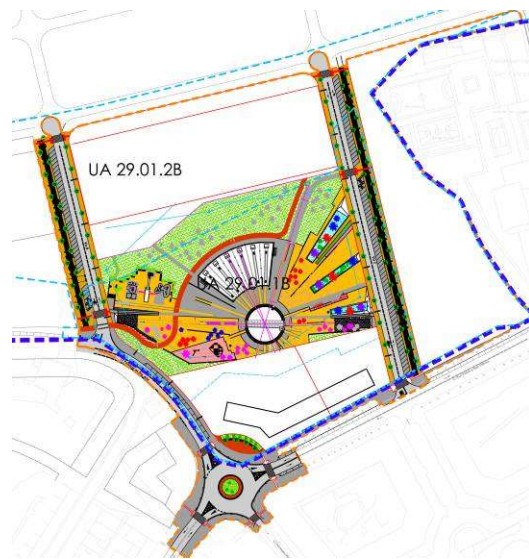
Figura 7. Detalle de la planta de conjunto -obra ejecutada hasta 2007- del Proyecto de Urbanización de la UA 29.01.1 (Fuente: Ayuntamiento de Burgos).
