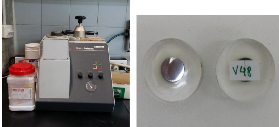
Figura 4.6: Izquierda: maquina de empastillado y metacrilato empleado. Derecha: resultado de la probeta empastillada y etiquetada
