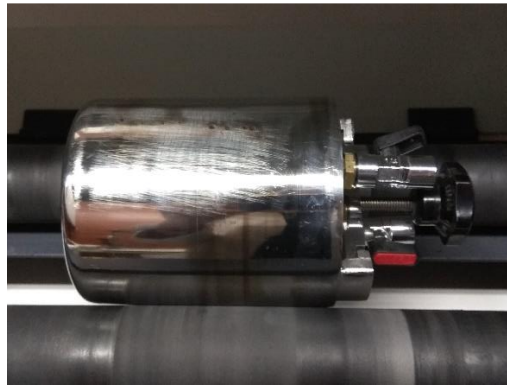
Figura 4.1: Cilindro cerrado colocado sobre los rodillos del molino
