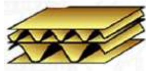
Figura 71. Esquema cartón corrugado de pared doble.
