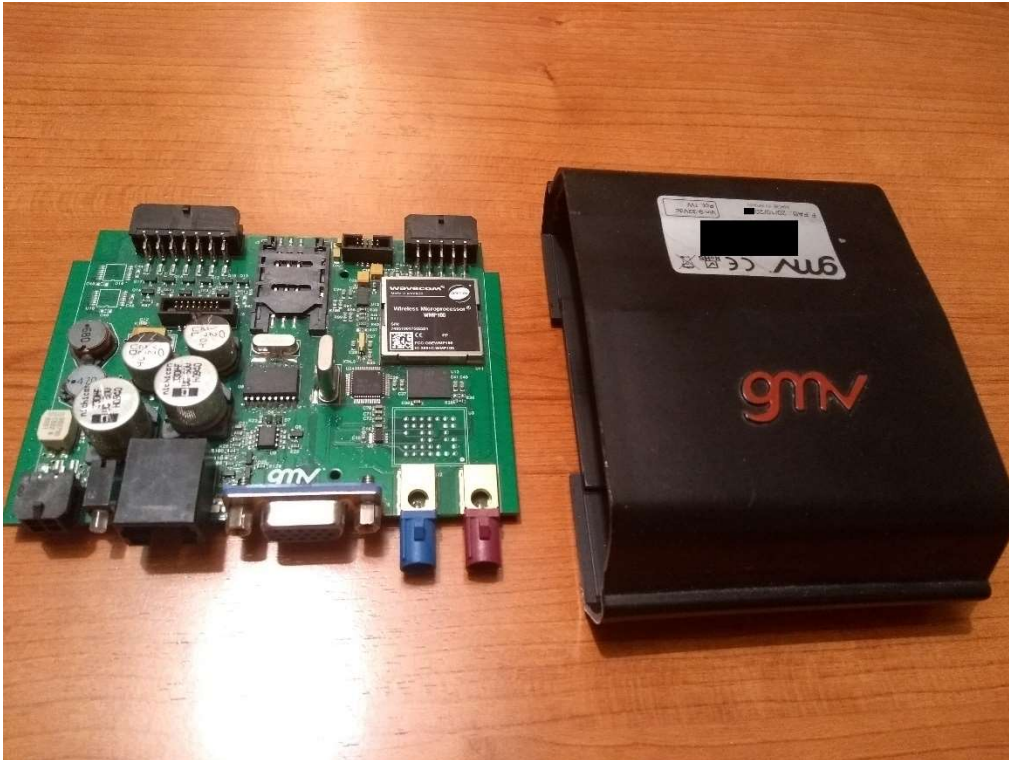
Ilustración 1: TCU destinada a ser colocada en un vehículo de transporte público (GMV)
