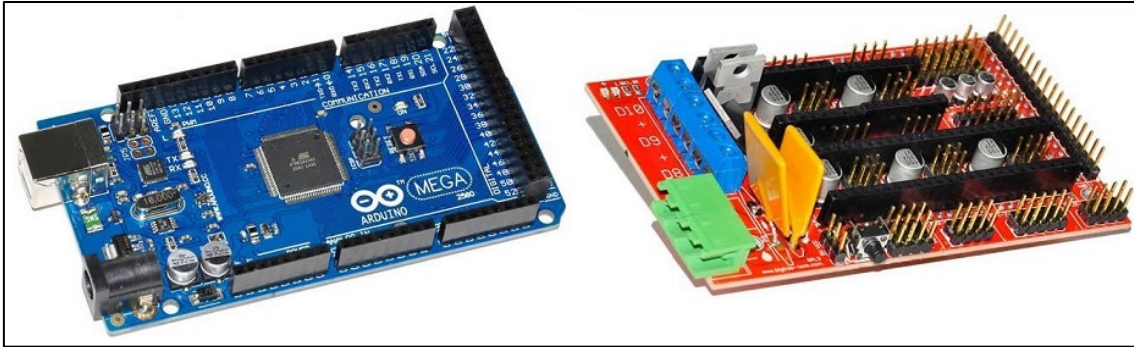
Ilustración 48: Placa Arduino Mega 2560 y RAMPS. Fuente: BPMSat. Ref: [41]
