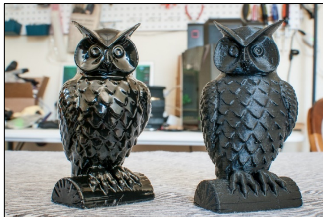
Ilustración 68: Pieza de ABS sometida a un baño en acetona. Fuente: StackExchange. Ref: [43]
