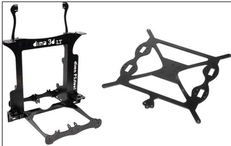
Ilustración 43: Chasis principal y soporte de la base de impresión. Fuente: BPMSat. Ref: [41]
