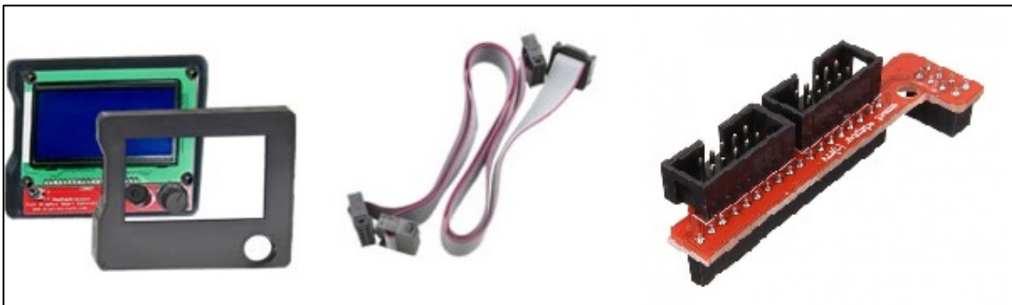
Ilustración 60: Controlador con LCD, cable de bus y conector a RAMPS. Fuente: BPMSat. Ref: [41]
