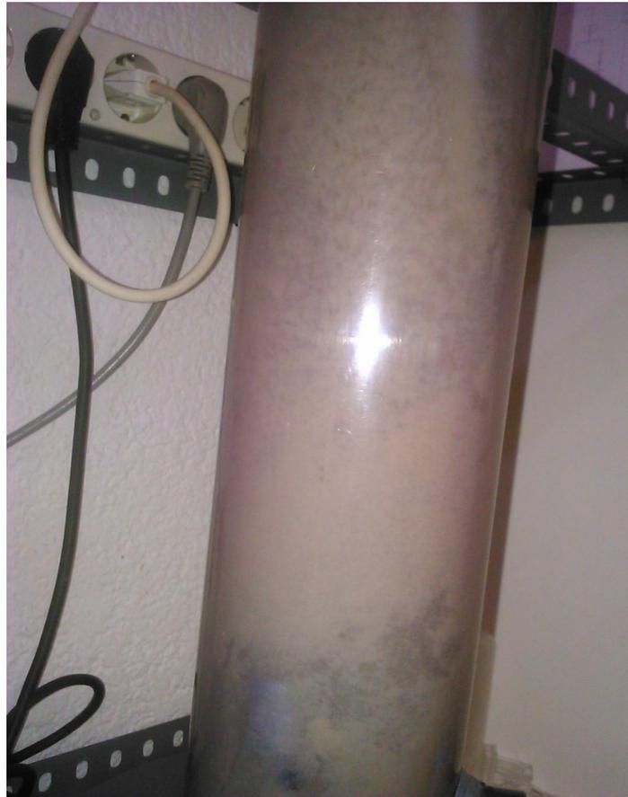
**Figura AIII.3.** Detalle de la fijación de la biomasa a las paredes del reactor por falta de agitación.
