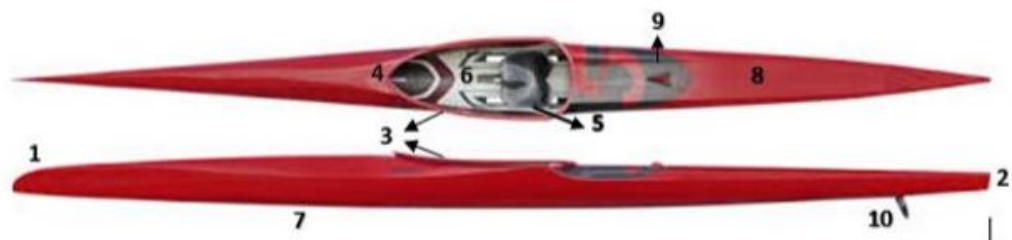
Figura 1 kayak con numeración de sus partes. Proa (1), parte delantera de la embarcación; popa (2), parte trasera; Bañera (3) apertura central de la embarcación, donde se introduce el palista Reposapiés (4) parte móvil donde se apoyan los pies Asiento (5) parte móvil de la embarcación, donde va sentado el palista Rejilla (6) vías sobre las que está fijado el asiento Casco (7) mitad inferior de la piragua Cubierta (8) mitad superior de la piragua Portatablillas (9) Pieza sobre la que se coloca el dorsal Timón (10) Maneja la dirección del barco
