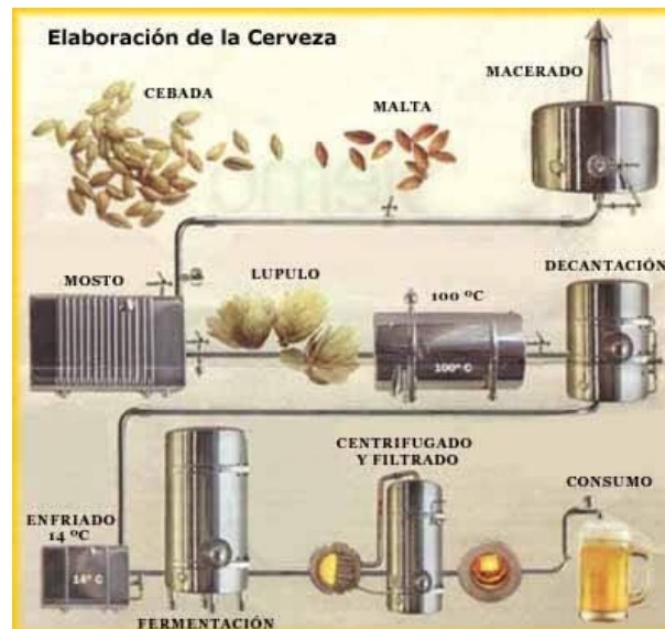
Figura 8 Proceso de elaboración de cerveza
