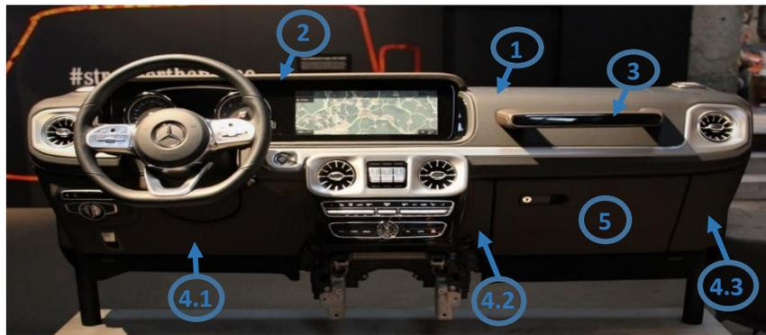
Imagen 1.5. Panel de instrumentos del Mercedes-Benz Clase G (1. Salpicadero; 2. Embellecedor; 3. Tirador; 4.1. Bajo Volante 1; 4.2. Bajo Volante 2; 4.3 Bajo Volante 3; 5. Guanterera). Recuperado de <https://www.motorpasion.com>
