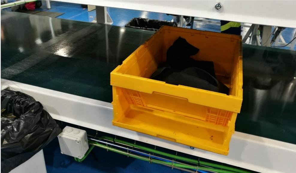
*Imagen 5.7. Pieza cosida sobre una de las bandas transportadoras. Fuente: Elaboración propia*
