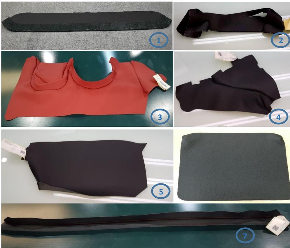
Imagen 3.12. 1. Embellecedor; 2. Tirador; 3. Bajo Volante 1; 4. Bajo Volante 2; 5. Bajo Volante 3; 6. Guantera; 7. Consola central superior. Fuente: Elaboración propia
