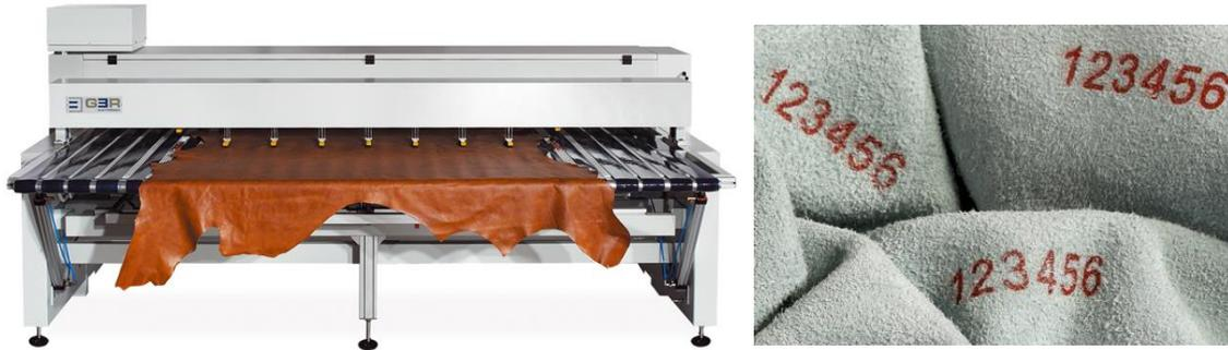
Imagen 6.3. Máquina de estampado GER Elettronica (izquierda) y número de lote marcado en la cara no vista del cuero (derecha). Fuente: <http://www.gerelettronica.com>
