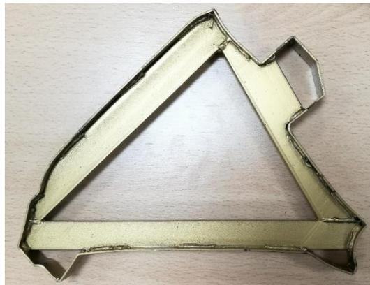
*Imagen 2.10. Troquel del proyecto BR463 G-Class utilizado en la etapa de troquelado. Fuente: Elaboración propia*
