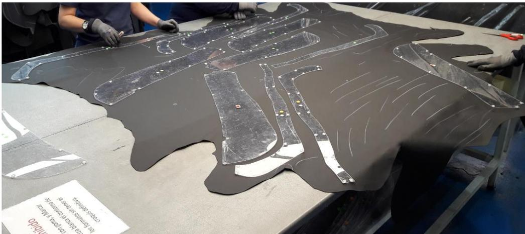
Imagen 2.6. Operación de marcado de piel dibujando la silueta de los formatos que después serán troquelados. Fuente: Elaboración propia
