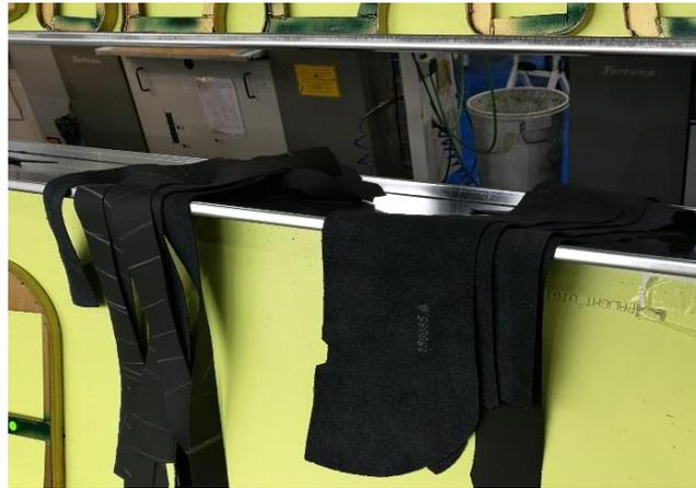
*Imagen 4.15. Hueco de paso de los formatos de la troqueladora a la rebajadora. Fuente: Elaboración propia*
