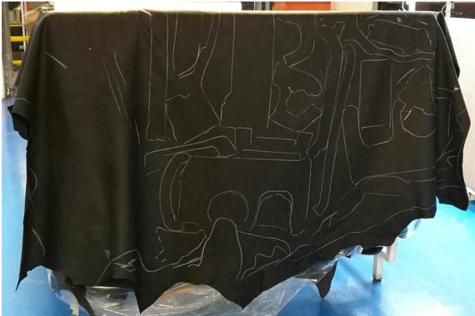
*Imagen 2.7. Pieles marcadas con el contorno de las piezas que serán cortadas en el siguiente puesto. Fuente: Elaboración propia*
