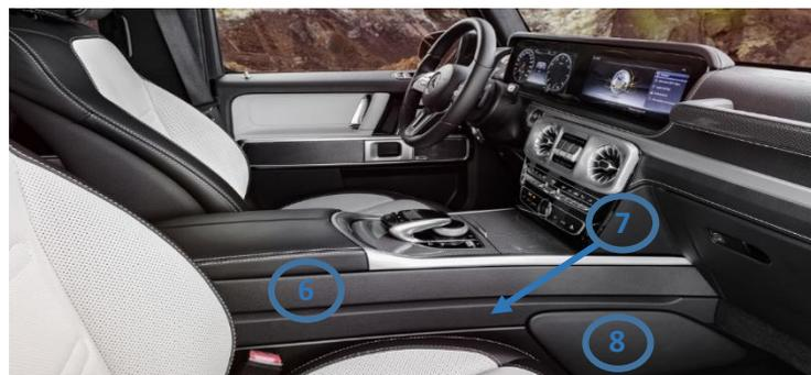
Imagen 1.7. Consola central del modelo Clase G 2018 de Mercedes-Benz (6. Consola central superior; 7. Consola central inferior; 8. Apoya-rodillas). Recuperado de <https://www.coches.com>
