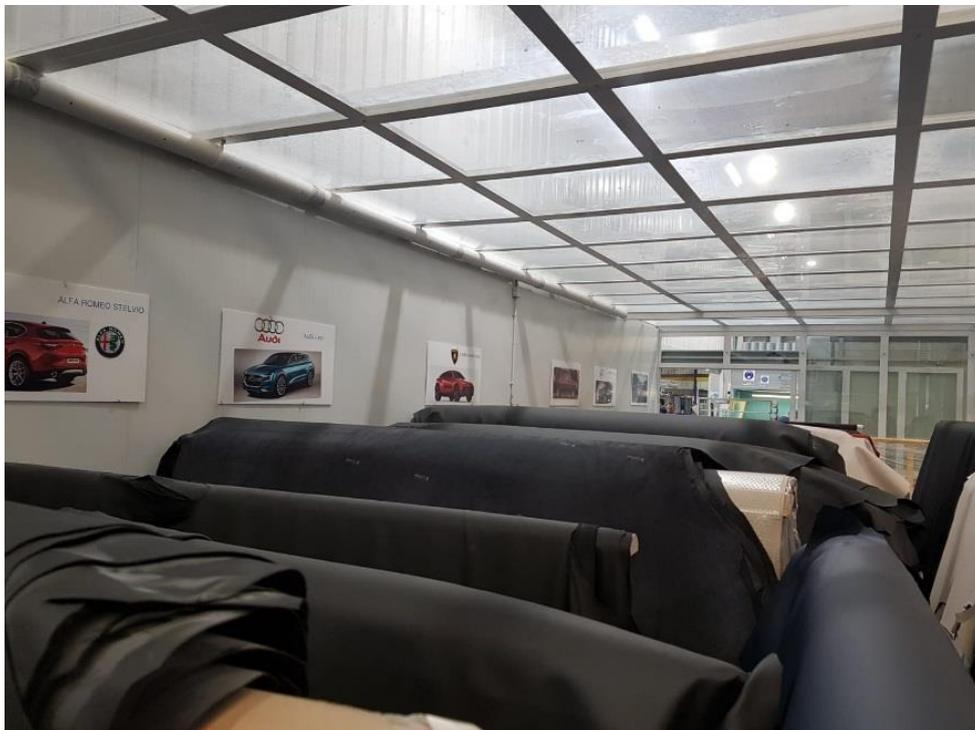
*Imagen 4.8. Cámara de temperatura y humedad para las pieles de cuero. Fuente: Elaboración propia*
