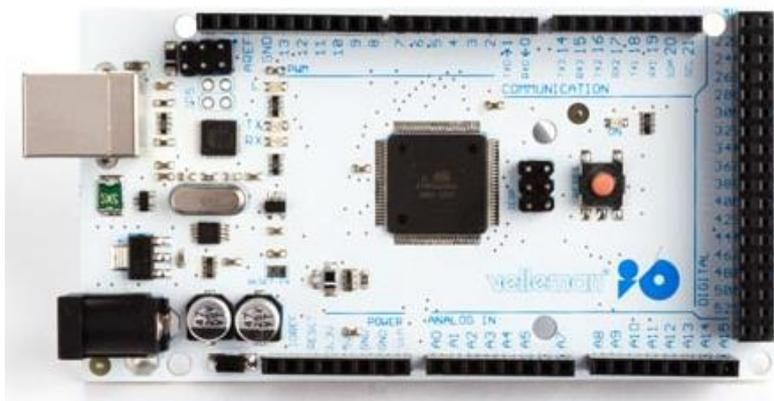
*Figura 91 Placa de Arduino Mega de la marca Velleman*
