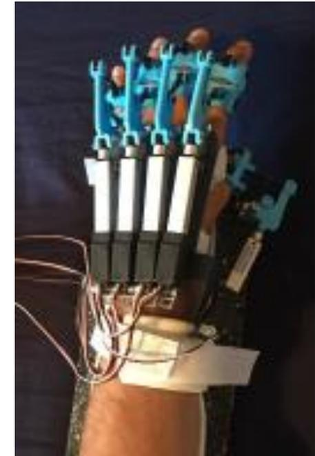
Exoesqueleto diseñado en el proyecto
