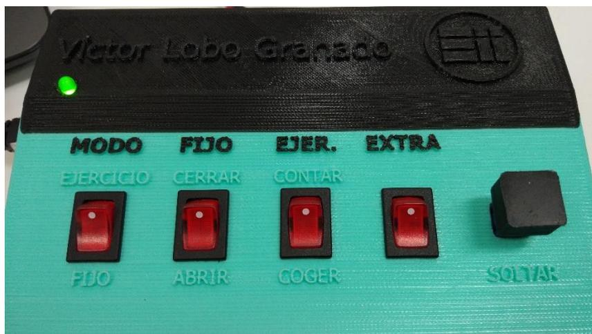
Figura 100 Panel de interruptores para el control del exoesqueleto
