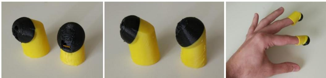
*Figura 38 Prototipo 5 de dedal en dos materiales*
