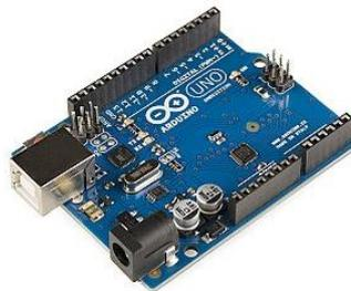
Figura 53 Placa de Arduino UNO
