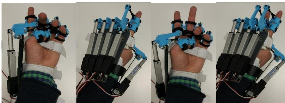
*Figura 103 Exoesqueleto en MODO CONTAR*
