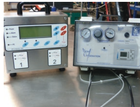
Figura 5. Sistemas de dosificación másico (izquierda) y volumétrico (derecha).
