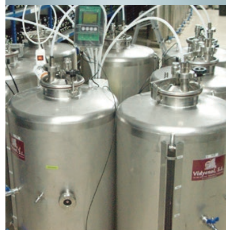
Figura 14. Vista del análisis de la permeabilidad del tubo de polydimetil-siloxane (silicona) en cuatro longitudes diferentes por duplicado para el análisis de la permeabilidad lineal del tubo en depósitos de 80 litros
