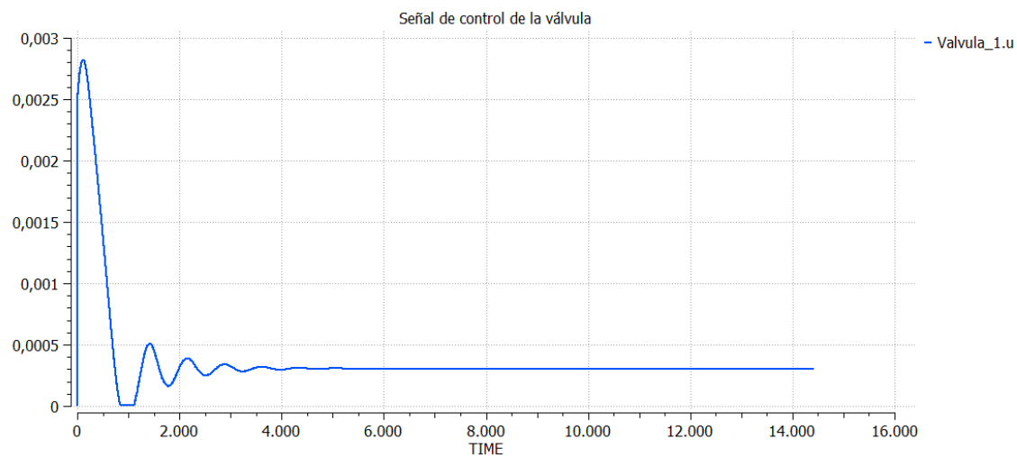
Figura 6.2.7: Señal de control de la válvula
