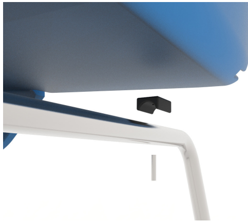
Fig. 78. Vista explosionada del sistema de unión.
