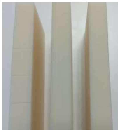
Imagen 4.4.1: Probetas de lado, de izquierda a derecha fabricadas a 21°C, 40°C y 60°C respectivamente.
