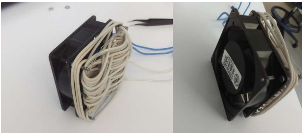
Imagen 3.1.3.1: Resistencia flexible en ventilador.
