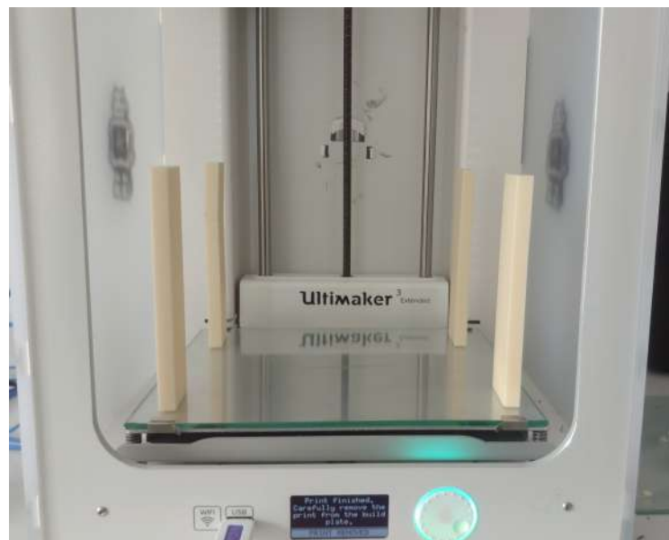
Imagen 4.1.1: Probetas impresas a lo largo de la placa.
