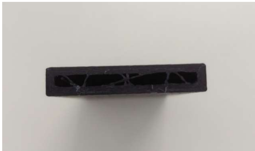
Imagen 1.2.1: Pieza partida a la mitad con un relleno del 20%.
