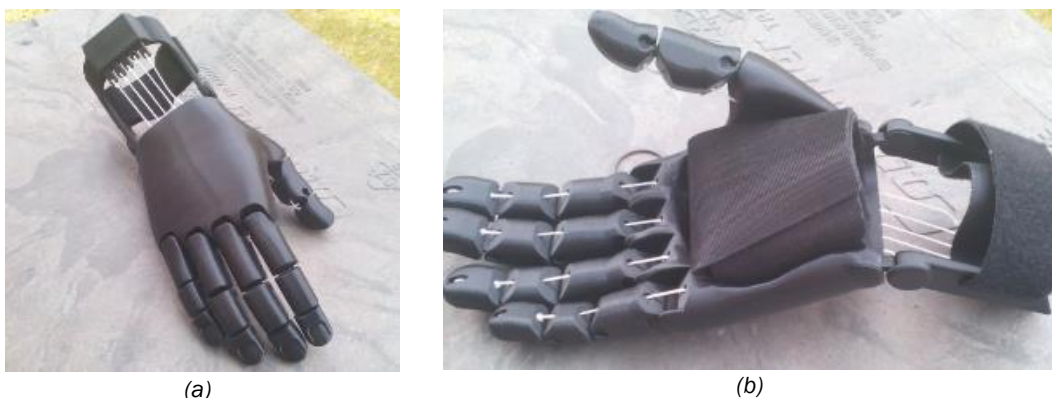
Figura 26. Prótesis Flexy Hand, superficie externa (a) e interna (b) [16]
