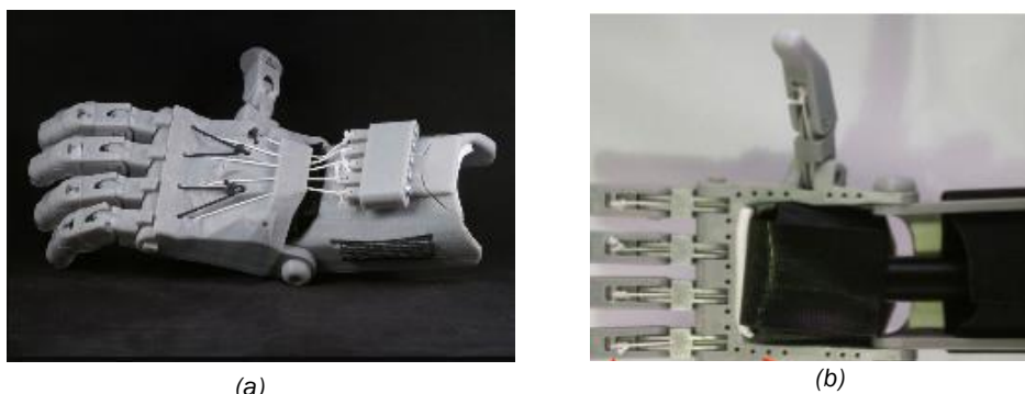
Figura 21. Prótesis Raptor Hand, superficie externa (a) e interna (b) [16]
