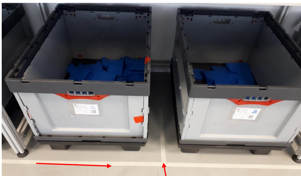
Figura 4.41. Marcación de suelos
