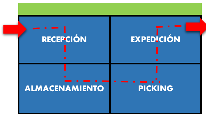
Figura 3.12. Distribución de flujos en T
