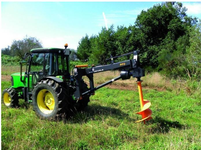
*Ilustración 3. Detalle de un ahoyador para la plantación*
