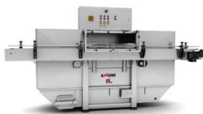
Ilustración 9. Limpieza de recipientes de vidrio (exterior)
