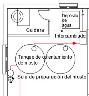
Imagen 18: Diseño en planta de la sala de preparación del mosto.
