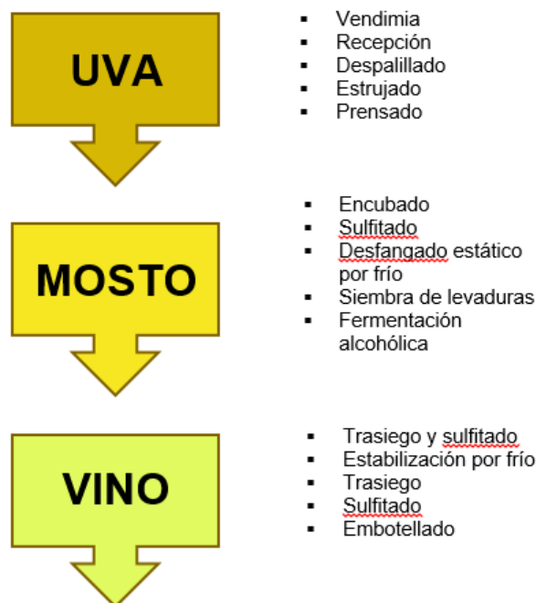
Figura1. Diagrama de flujo del proceso de vinificación realizado
