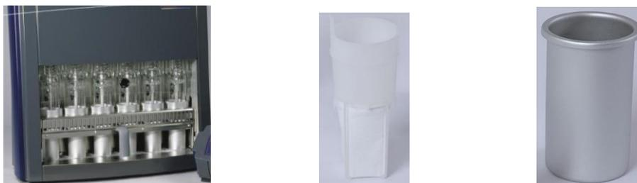
*Fig.3.2. Componentes del equipo Soxtec. De izquierda a derecha: extractor Soxtec 2058, hidrocápsula y vaso metálico.*
