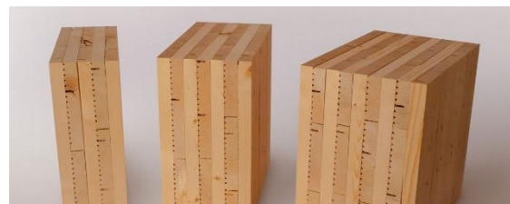
Figura 24. Paneles de madera laminada estructural encolados.
