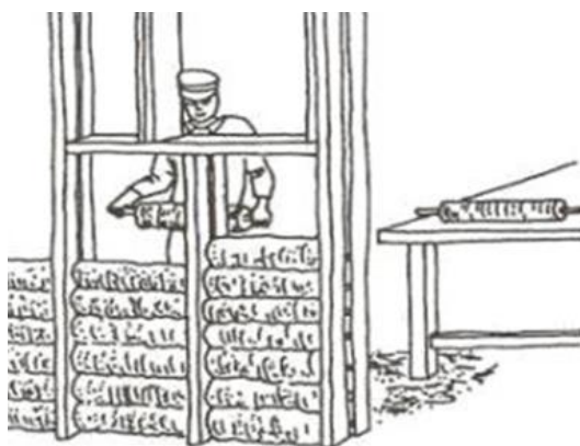
Figura 18 y 19. Técnicas tradicionales adaptadas a sistemas constructivos actuales. Entramado de Barro y paja
