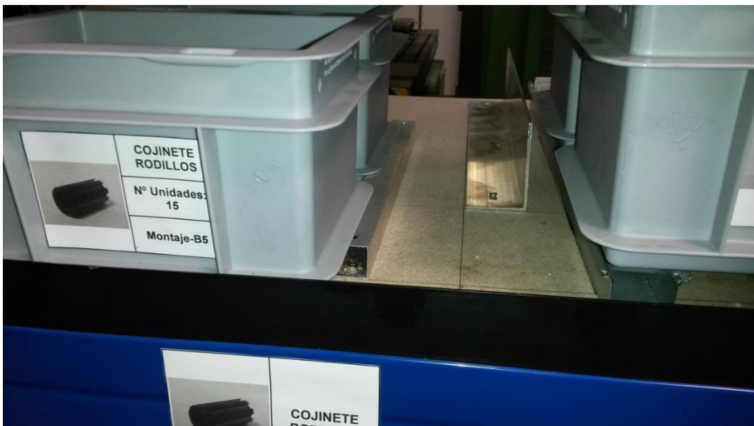
Figura 22: Vista guías con rodillos y con perfiles cuadrados fijos.
