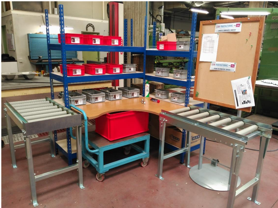
Figura 10: Puesto de montaje en la fase 2.
