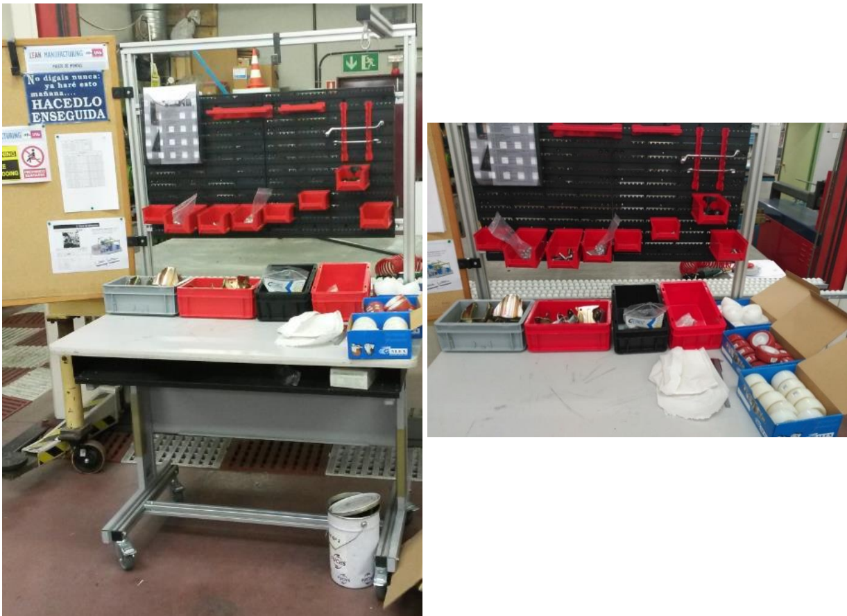
Figura 8: Puesto de montaje en la fase inicial.
