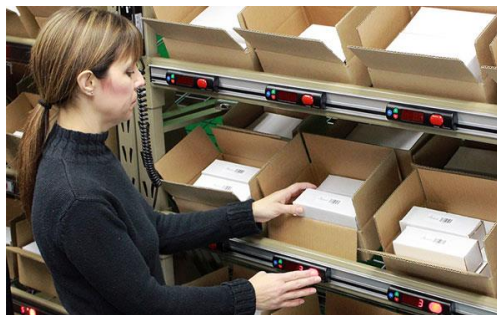
Figura 5: Ejemplo real de un sistema de pick-to-light. Fuente: Cisco-Eagle Material Handling Solutions & Conveyor Systems.
