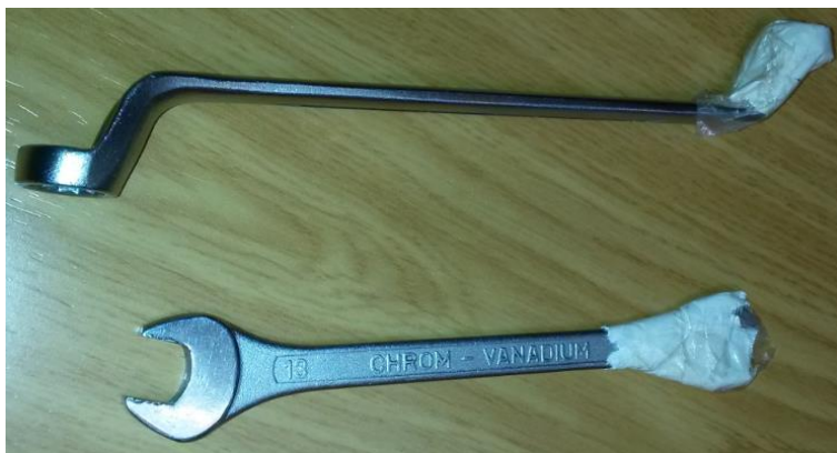
Figura 19: Llaves plana y de codo con Poka-yoke.
