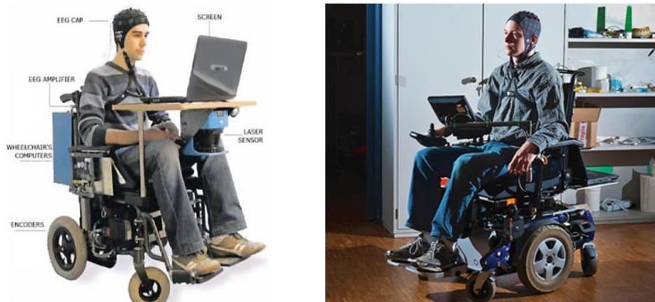
FIGURA 2.15: Control de una silla de ruedas mediante EEG [35].
