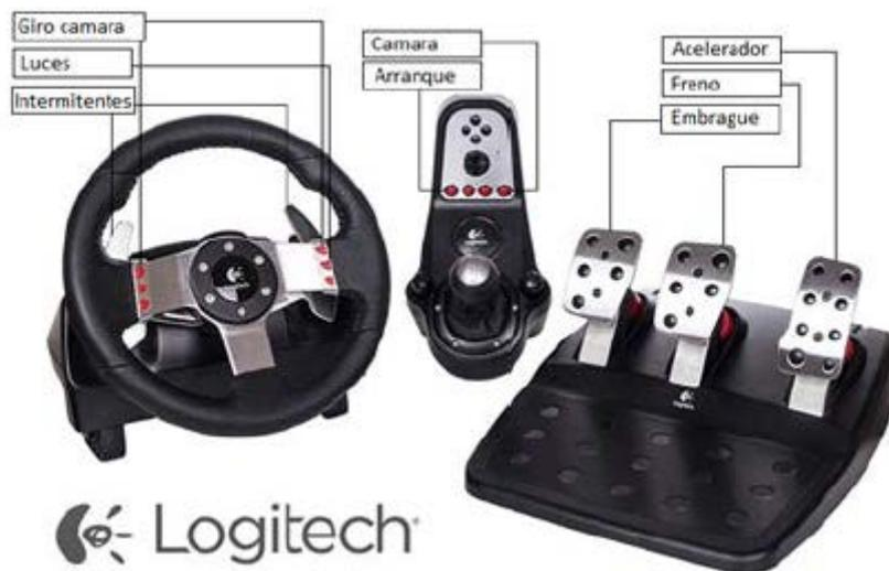
Figura 49. Controles establecidos en el dispositivo Logitech.
