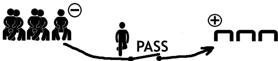
Imagen 13. Circuito eléctrico con interruptor cerrado.
