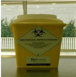
Imagen 32. Contenedor residuos grupo III.
