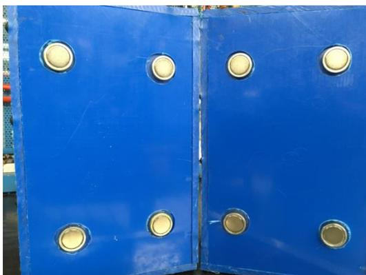
Ilustración 47: Detalle imanes prototipo
