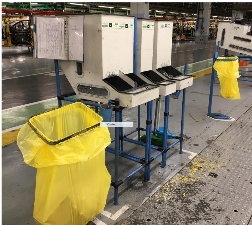
Ilustración 55: Solución para no depositar tapones en la lugette
