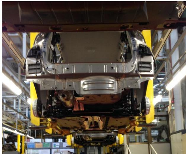
Ilustración 28: Imagen del vehículo una vez realizado el acostaje.
