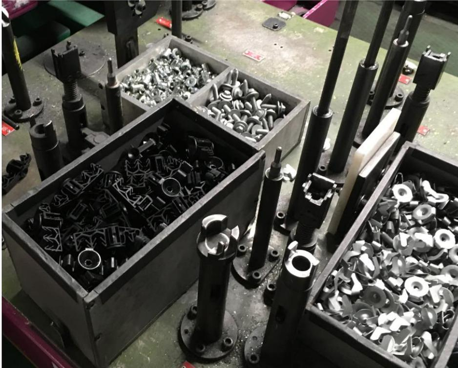
Ilustración 41: Imagen de sobrerrelleno de las cajas
