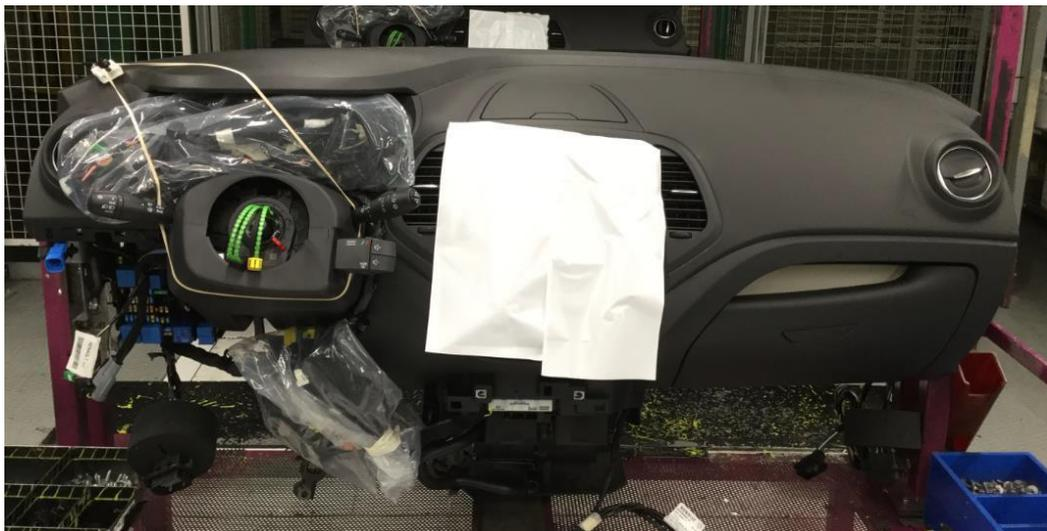
Ilustración 26: Tablero de bordo ya montado
