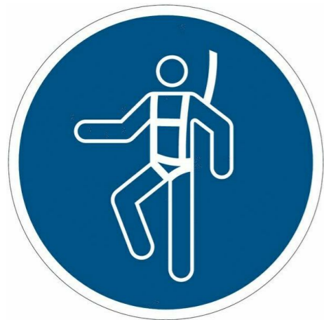
1. Uso obligatorio de protección anticaída.
