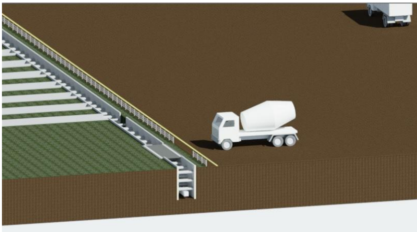
Figura 22. Detalle cimentación: zapatas y vigas riostras. Fuente: Elaboración propia a partir de tecnología BIM.
