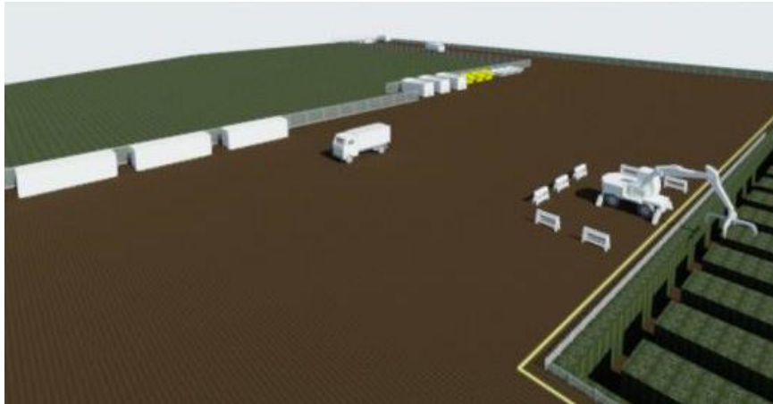
Figura 17. Organización de obra: acceso de camiones y tránsito de peatones.
