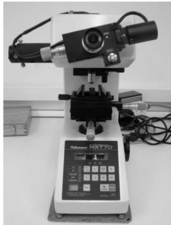
Ilustración 3.24: Microdurómetro.
