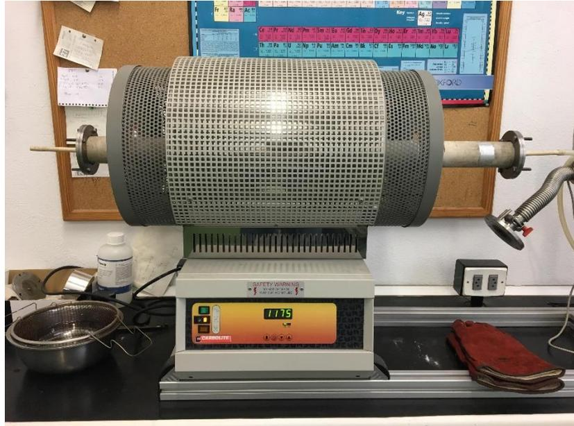
Ilustración 3.3: Horno cerámico horizontal Carbolite STF 15/180.
