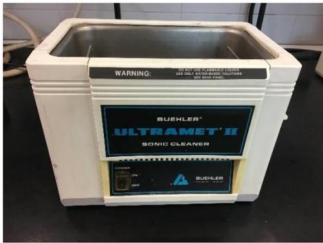
Ilustración 3.9: Máquina ultrasonidos Ultramet II.
