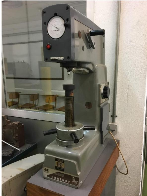
Ilustración 4.14: Medidor de dureza CENTAUR RB2.
