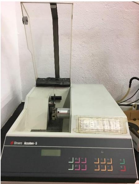
Ilustración 3.4: Tronzadora Struers accutom-5.
