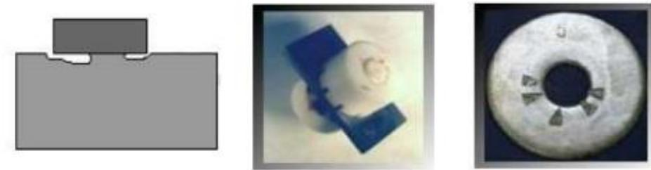
Ilustración 2.14: Corrosión por grietas. [42]
