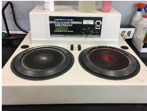
Ilustración 3.11: Máquina de pulido Buehler Metaserv.
