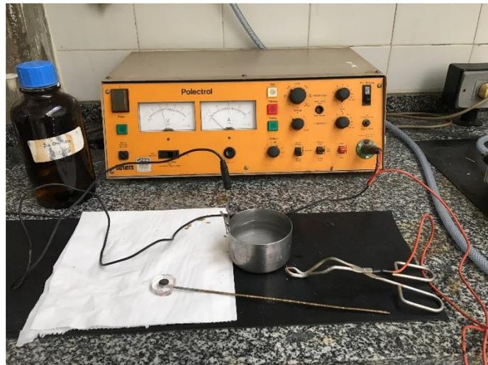
Ilustración 3.22: Equipo utilizado para el ataque electroquímico.
