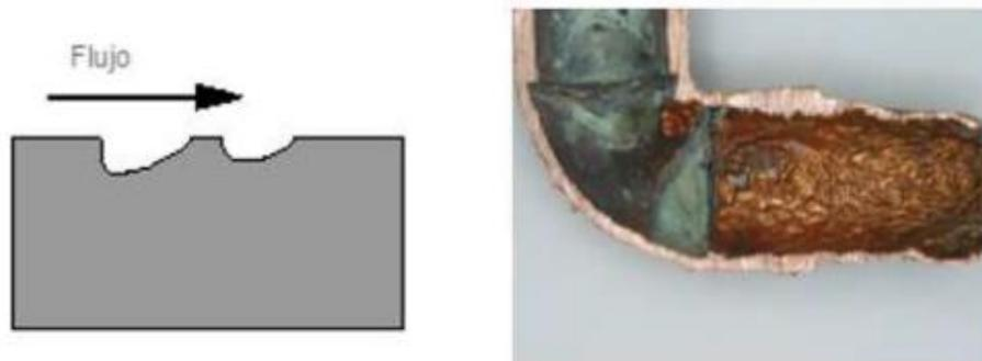
Ilustración 2.16: Corrosión por erosión. [42]
