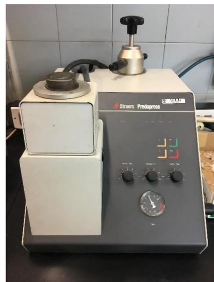
Ilustración 3.6: Máquina de empastillado.
