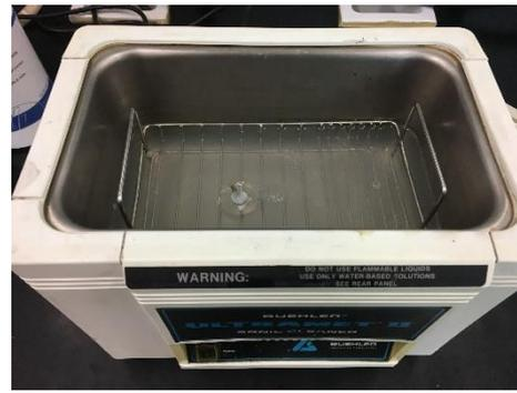
Ilustración 3.10: Detalle de una probeta en el baño de ultrasonidos.
