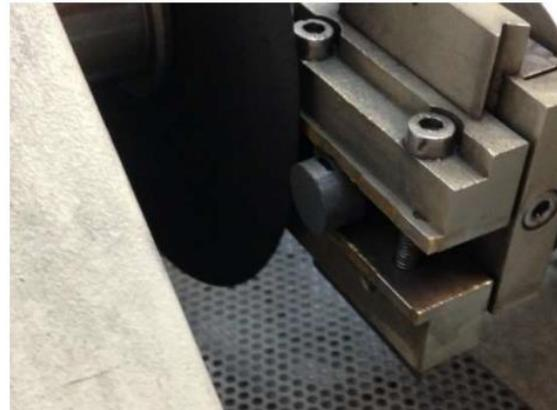
Ilustración 3.5: Detalle de la sujeción de la probeta en la mordaza.
