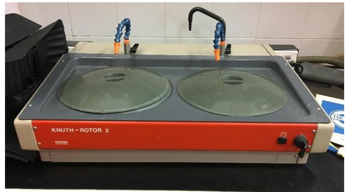
Ilustración 3.8: Máquina de desbaste fino Knuth-Rotor 2.
