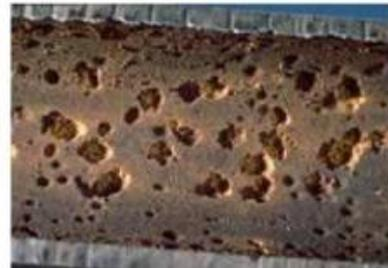
*Ilustración 2.13: Corrosión por picaduras. [42]*
