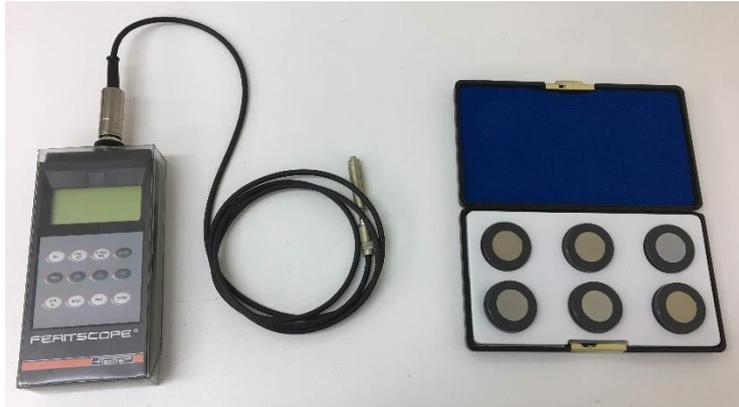
Ilustración 3.23: Magnetómetro utilizado con los diversos patrones de calibración.
