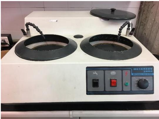
Ilustración 3.7: Máquina de desbaste grueso Metaserv 2000.
