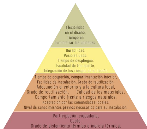
Diagrama 12. Pirámide jerárquica de las cualidades esenciales en un refugio de respuesta temporal o transitorio.
