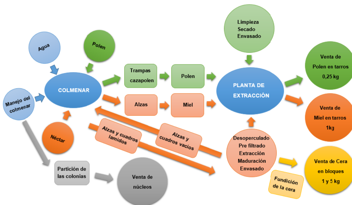
Figura 1. Diagrama de flujo de los procesos productivos implicados.
