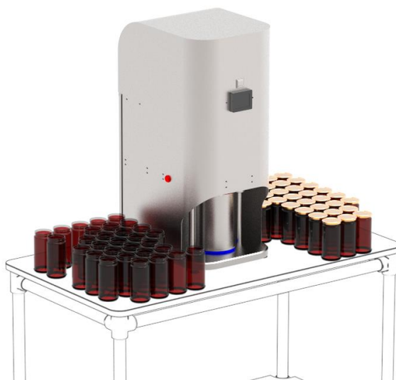
Imagen 14. Máquina cerradora de envases semiautomática.
