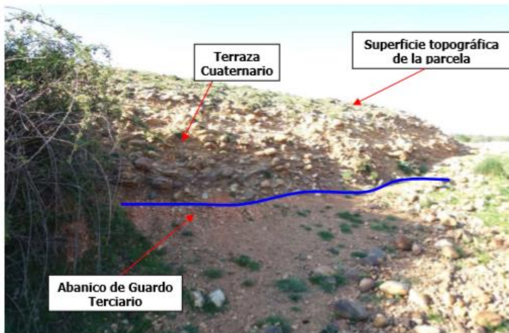
Imagen 2. Aspecto de los materiales que constituyen el subsuelo de la parcela objeto de estudio en taludes cercanos.
