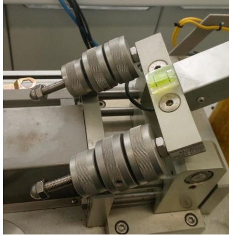
Figura 6.36: Elementos de calibración del brazo del tribómetro.
