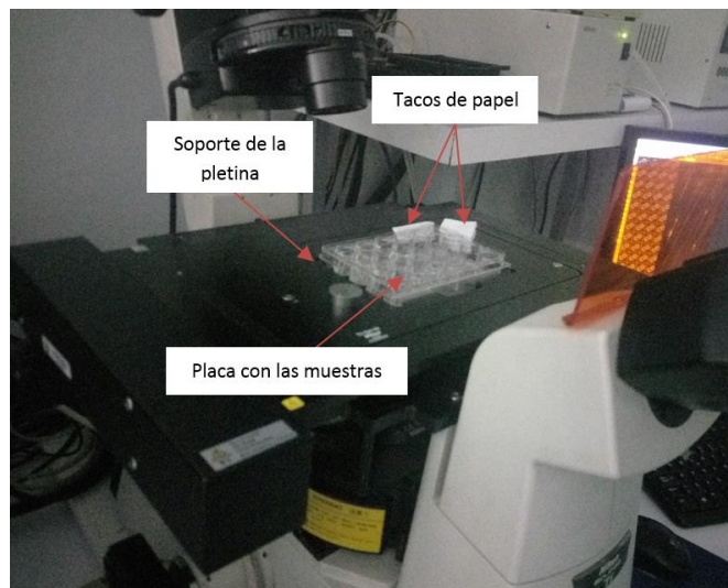
Figura 6.81: Detalle de la pletina y de los tacos de papel necesarios para la sujeción de la placa con las muestras.
