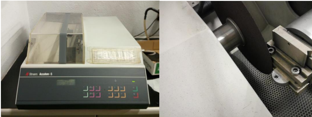
Figura 6.1: Detalle de la cortadora de precisión y de la sujeción de la probeta en la mordaza.
