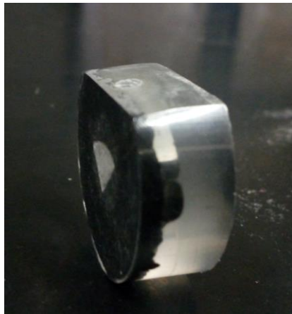
Figura 6.5: Detalle de una probeta empastillada utilizando una combinación de baquelita y metacrilato.
