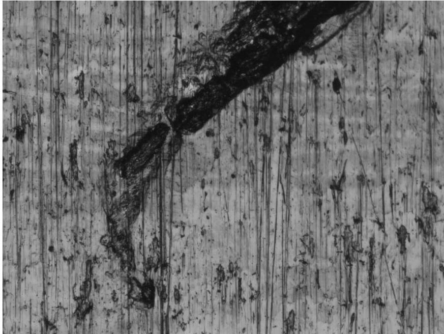
Figura 10.79: Estado superficial a 100 aumentos de la probeta tratada superficialmente mediante la técnica de oxidación anódica tras la realización de los ensayos de corrosión.
