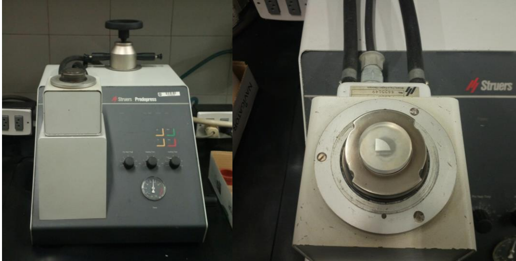
Figura 6.6: Prensa metalográfica y probeta empastillada en metacrilato.
