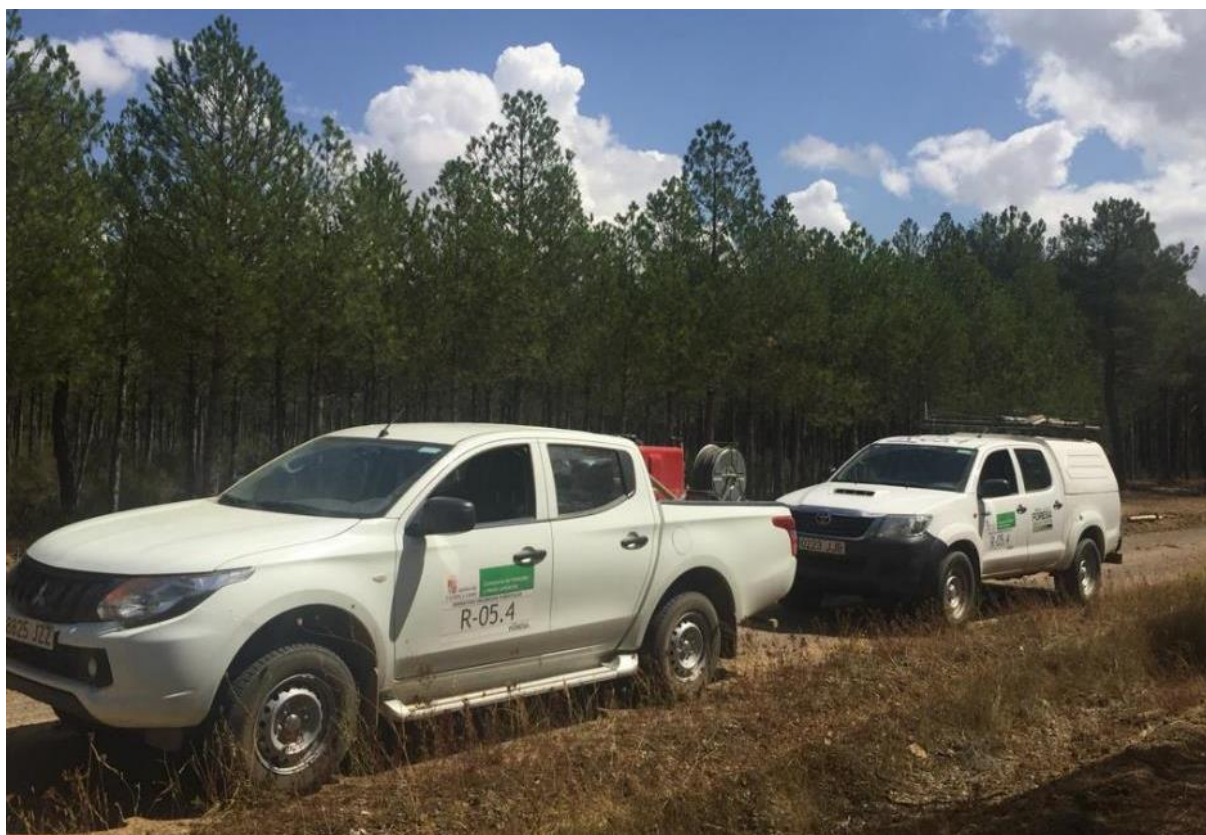
Figura 31. Vehículos todo terreno, equipado con depósito de 500l y bomba de alta presión del Romeo 05.4 realizando trabajos en la comarca de La Valdavia. Fuente: Servicio Territorial de Medio Ambiente de Palencia.
