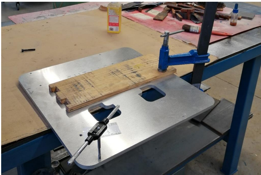
Figura 41. Placa fijada a la mesa mediante un gato para el roscado de algunos de sus taladros
