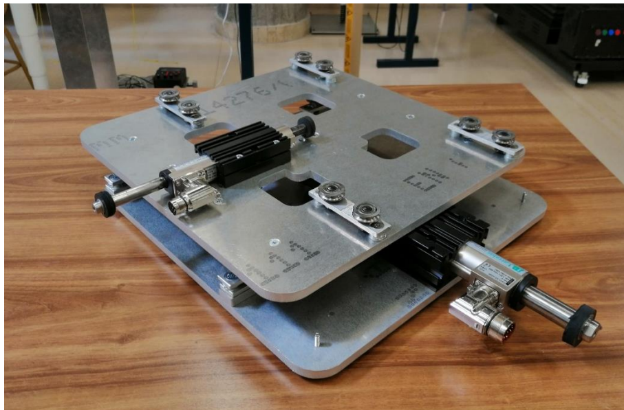
Figura 53. Montaje de los rodamientos del módulo superior sobre la placa intermedia (incluida la colocación del motor)
