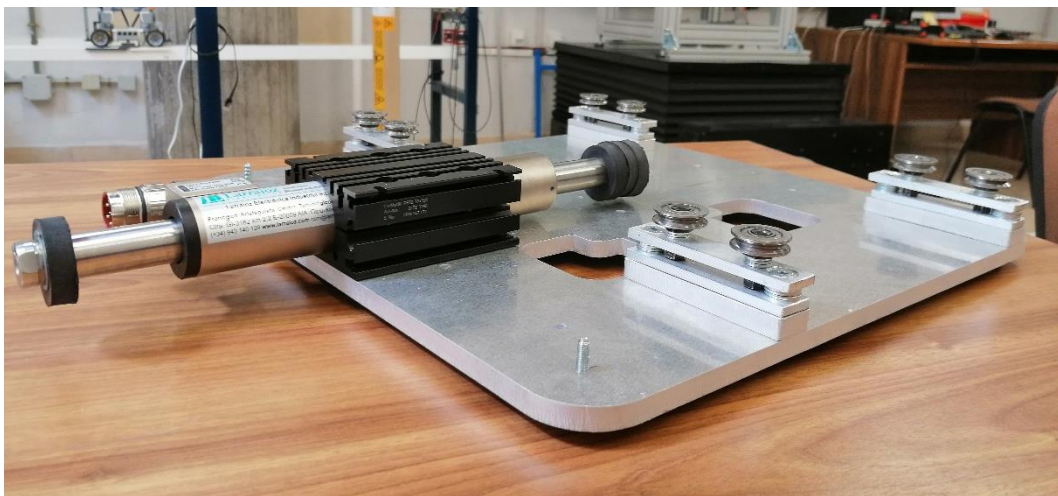
Figura 49. Placa inferior totalmente montada (incluido el motor)
