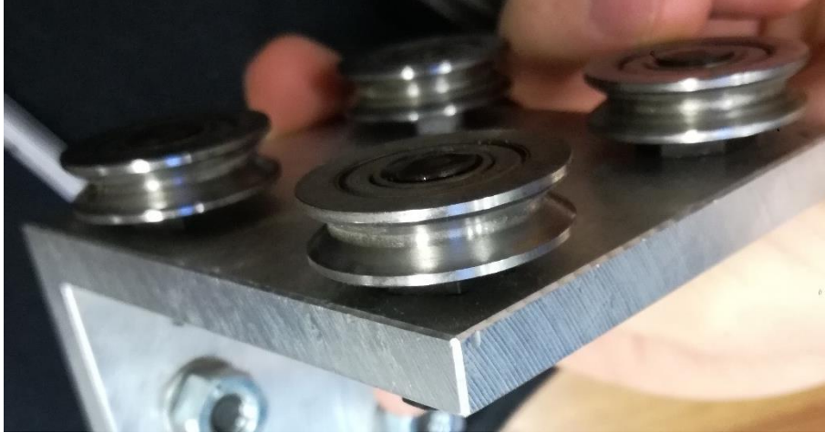
Figura 16. Rodamientos Slimline GLJ265C y GLJ265E montados sobre un carro
