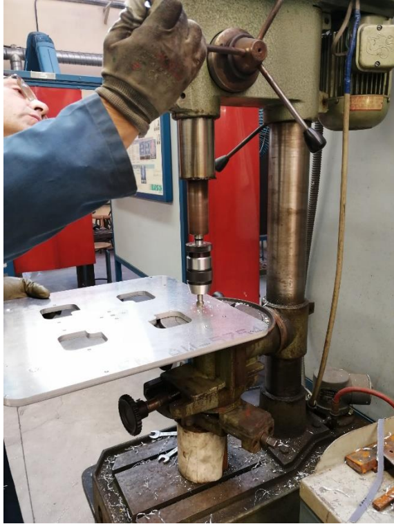
Figura 39. Mecanizado de una de las placas mediante un taladro de columna
