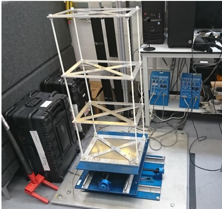
Figura 3. Mesa sísmica de dos grados de libertad formada por la unión de dos módulos de un grado de libertad
