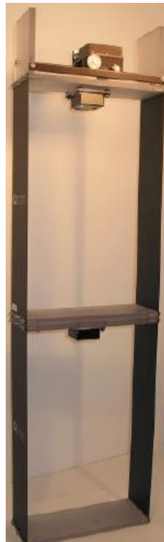
Figura 4. Maqueta de edificio multiplanta formada por dos módulos de una planta con el sistema AMD 2 y acelerómetros instalados.
