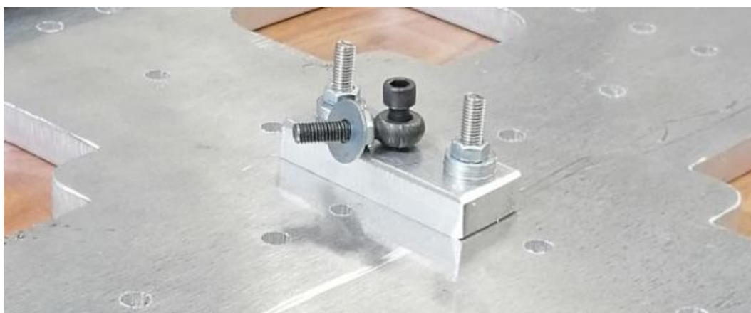
Figura 50. Detalle de la parte de la unión central instalada en la placa intermedia
