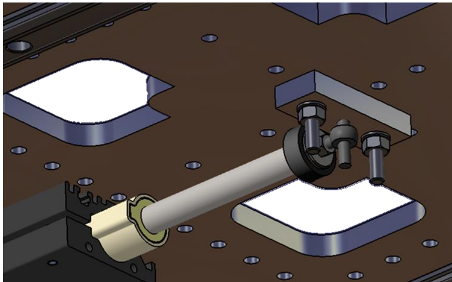
Figura 17. Detalle del diseño de la unión del motor con la placa superior
