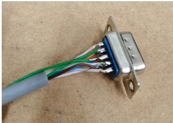
Figura 61. Detalle de la soldadura del conector DB-9 "macho" en el extremo del driver
