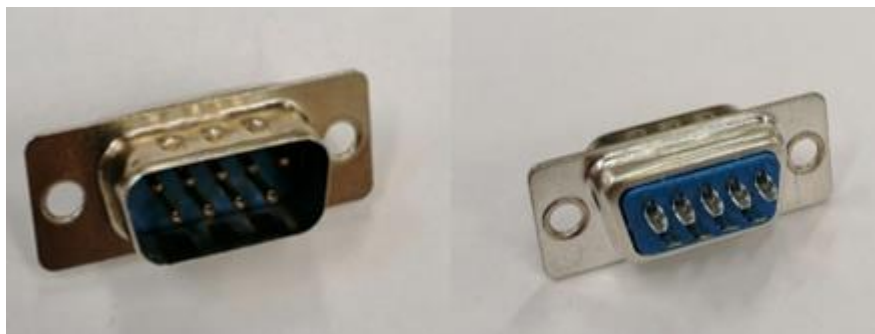
Figura 29. Conector DB-9. En el anverso (izquierda) se observan los pines mientras que en el reverso (derecha) se ven las patillas a las que soldar los cables
