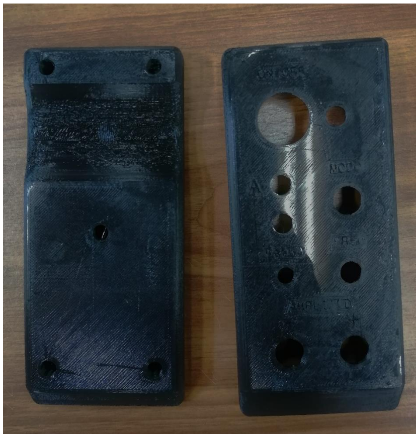
Figura 43. Resultado de fabricación del mando: parte inferior (izquierda) y parte superior (derecha)
