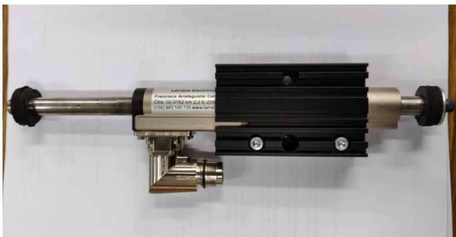
Figura 46. Motor del módulo superior montado por completo a falta del tornillo de ojo
