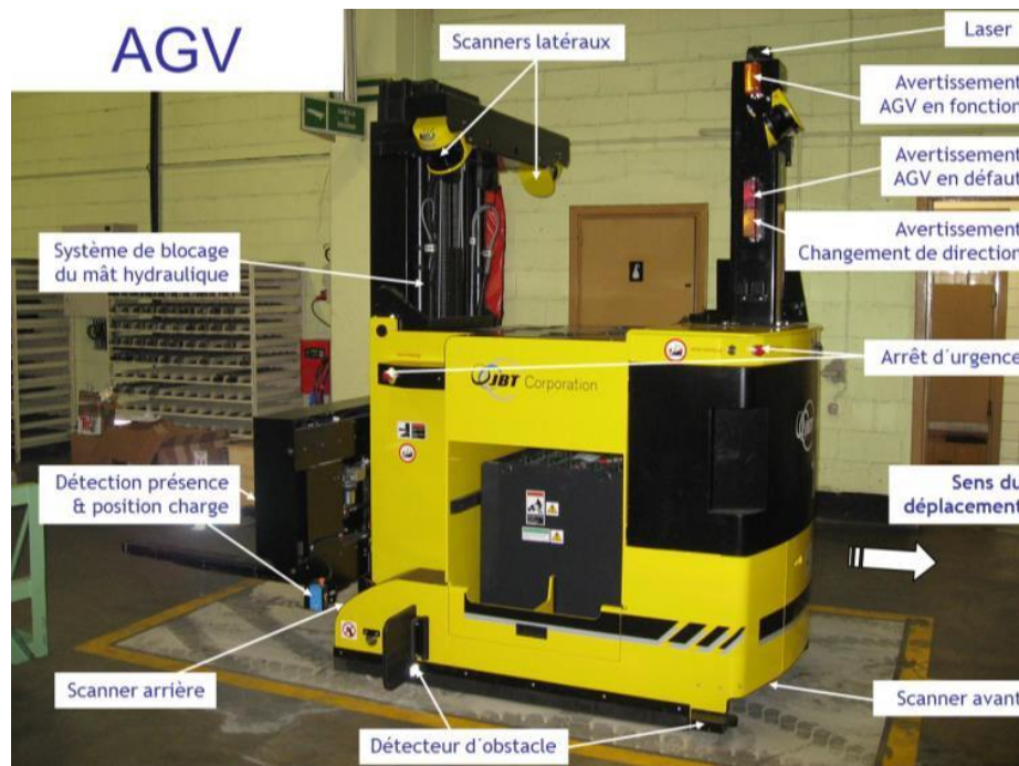
Figura 1.7. AGV "Garbo" y sus diferentes sensores.
