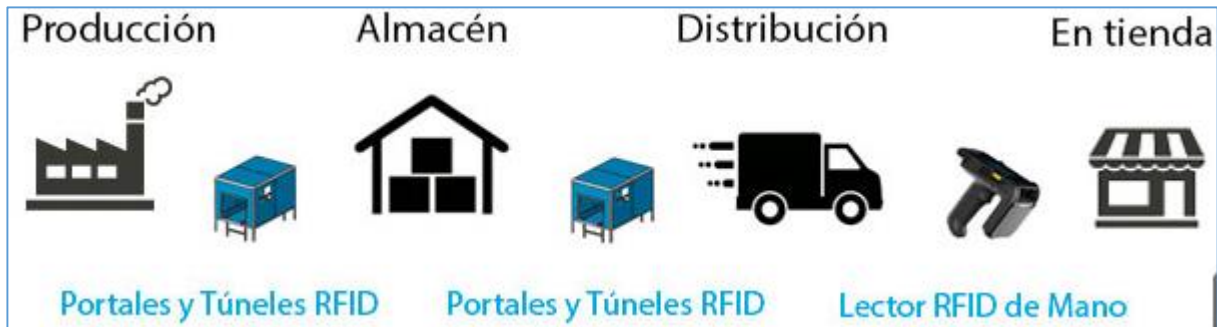
Figura 3.4: Trazabilidad producto a lo largo de la cadena de suministro median RFID (Dipole, 2018)
