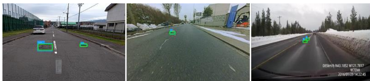
Figura 4.2: Detección de baches en carretera gracias al empleo Deep Learning (Arriola, 2018)
