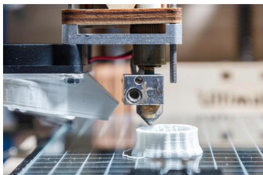
Figura 1.4: AM “ capa a capa ” (Barroso, 2018)
