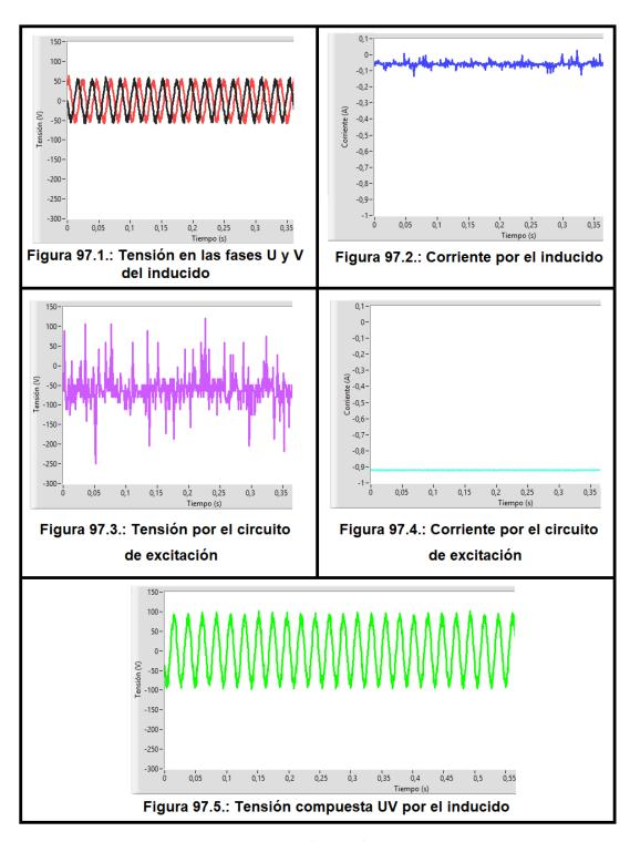
Figura 97: Resultados obtenidos para la máquina síncrona actuando como alternador
