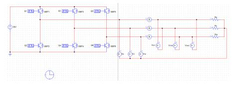
Figura 22: Circuito en PSIM con carga representada por tres resistencias de  $500\Omega$
