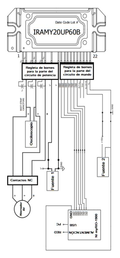
Figura 3: Esquema del circuito resultante de añadir los contactos NC y el alternador de 5V de tensión nominal al circuito esquematizado en la figura 2 de este anexo
