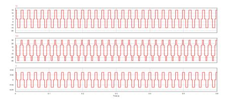
Figura 24: Tensión de fase U, tensión de línea UV y corriente para el circuito de la figura 22 con una tensión de alimentación de 30V y una frecuencia de conmutación de 50Hz
