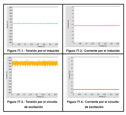
Figura 77: Resultados de la máquina de corriente continua actuando como generador de corriente continua girando a 350 rpm
