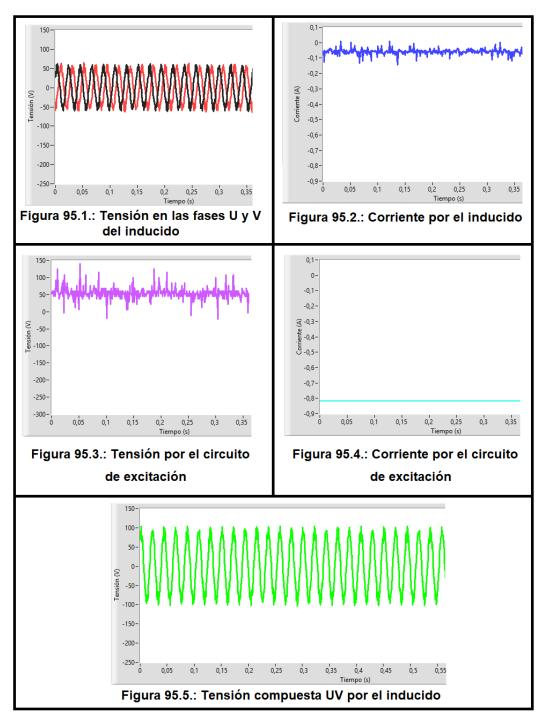
Figura 95: Resultados obtenidos para la máquina síncrona actuando como alternador
