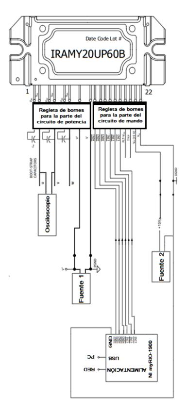
Figura 2: Esquema del circuito físico a crear con el fin de mejorar la respuesta producida por el circuito cuyo esquema se puede ver en la figura 1 de este anexo
