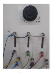
Figura 63: Regulador de tensión trifásico
