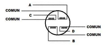
Figura 13: Motor paso a paso unipolar con 8 cables de salida
