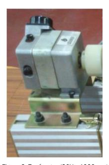
Figura 6: Tacómetro (30V x 1000rpm)
