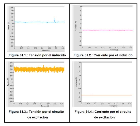
Figura 81: Resultados de la máquina de corriente continua actuando como generador de corriente continua girando a 750 rpm
