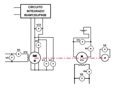
Figura 9: Sistema motor funcionando la máquina síncrona como generador síncrono
