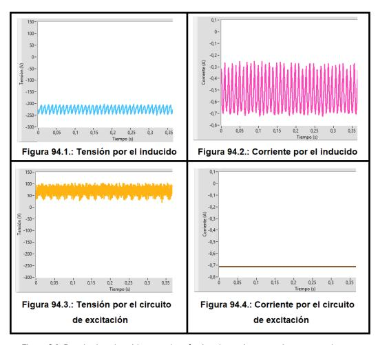
Figura 94: Resultados obtenidos para la máquina de corriente continua actuando como motor con una tensión de excitación de 100V
