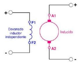
Figura 4: Máquina de corriente continua con sistema de excitación independiente ([5] página 30)
