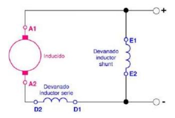
Figura 8: Máquina de corriente continua con sistema de excitación compound de larga derivación ([5] página 30)
