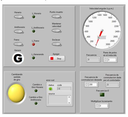
Figura 3: Parte de la interfaz de usuario que controla el sistema de tracción
