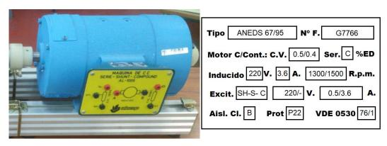
Figura 5: Máquina de corriente continua. Actúa como motor o generador de corriente continua. A su derecha se encuentra su tabla de características
