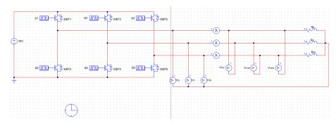
Figura 25: Circuito equivalente al sistema de control y la máquina síncrona de la figura 2 del anexo 4, conectada en estrella
