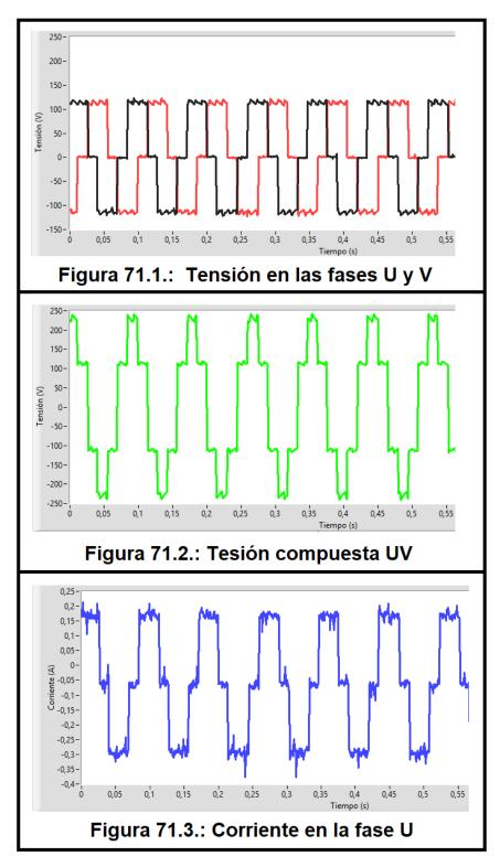
Figura 71: Resultados obtenidos de simular a una frecuencia de conmutación de 70Hz
