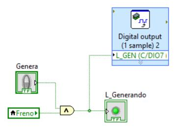
Figura 87: Sistema de bloques para que la máquina síncrona trabaje como alternador
