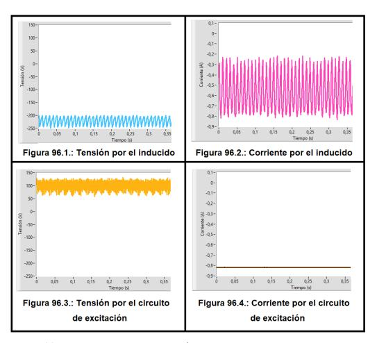
Figura 96: Resultados obtenidos para la máquina de corriente continua actuando como motor con una tensión de excitación de 140V
