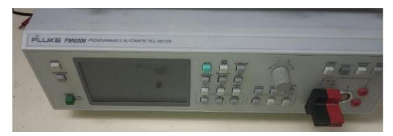
Figura 1: Medidor de resistencias, inductancias y capacitancias
