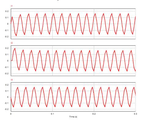
Figura 27: Corrientes de fase del circuito de la figura 25 simulado en PSIM con una tensión de alimentación de 30V y una frecuencia de conmutación de 50Hz
