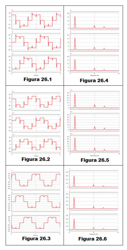
Figura 26: Resultados obtenidos de simular en PSIM el circuito de la figura 25 con una tensión de alimentación de 30V y una frecuencia de conmutación de 1Hz
