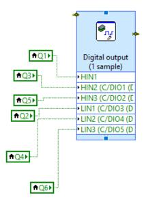
Figura 33: Bloque de salidas digitales que manda las señales de control al circuito integrado
