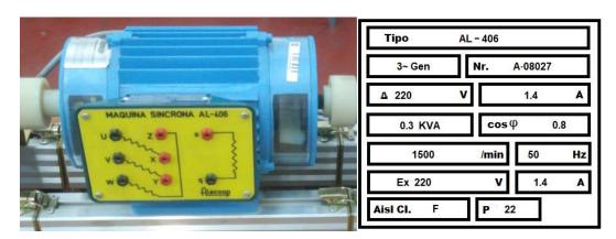
Figura 4: Máquina síncrona. Actúa como motor paso a paso o generador síncrono. A su derecha se puede ver su tabla de características
