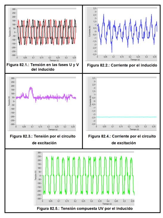
Figura 82: Resultados de la máquina síncrona actuando como motor paso a paso girando a 1000 rpm
