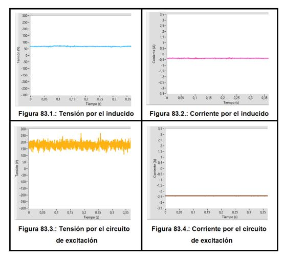
Figura 83: Resultados de la máquina de corriente continua actuando como generador de corriente continua girando a 1000 rpm
