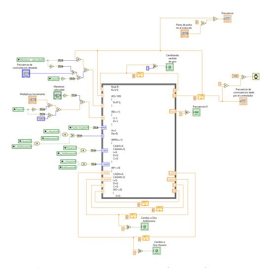
Figura 55: Sistema de bloques que discretiza la adquisición y generación de valores por parte del programa de control
