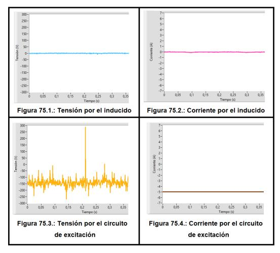
Figura 75: Resultados de la máquina de corriente continua actuando como generador de corriente continua girando a 100 rpm
