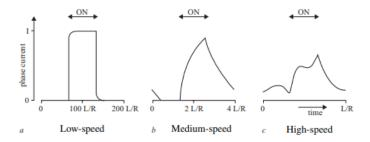
Figura 68: Forma de onda típica de la corriente a distintas velocidades de giro ([10] página 60)
