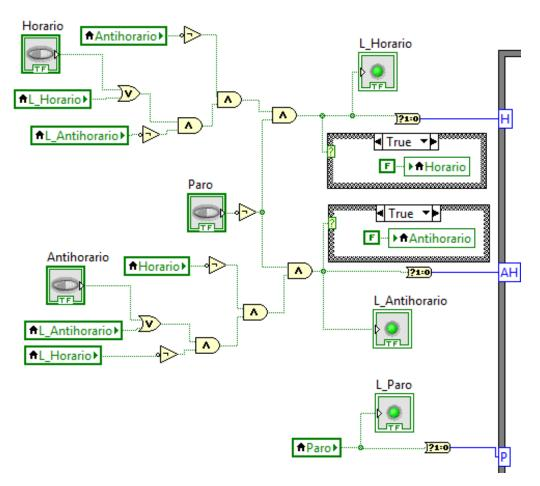
Figura 30: Sistema de bloques que permite la selección del sentido de giro y el paro del motor paso a paso
