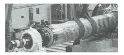
Figura 2: Máquina síncrona de rotor cilíndrico ([1] página 419)
