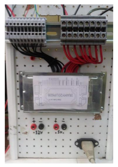
Figura 37: Circuito integrado IRAMY20UP60B junto a sus dos regletas de bornes
