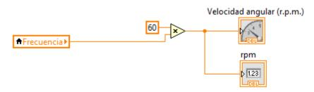
Figura 57: Sistema de bloques que conforma el indicador de velocidad
