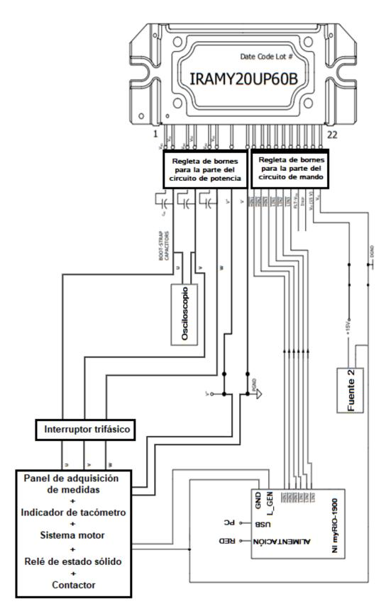
Figura 10: Esquema del circuito que conforma el sistema de tracción
