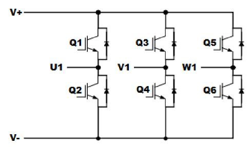
Figura 19: Inversor trifásico del circuito integrado
