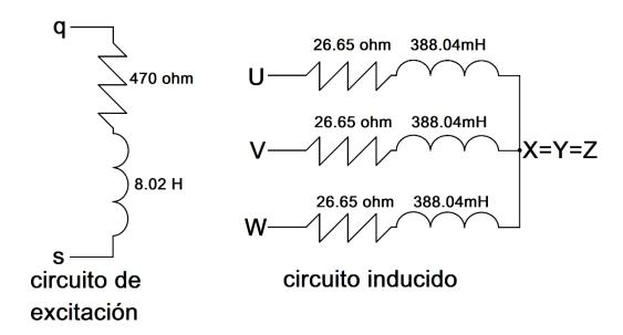
Figura 21: Circuito equivalente a la máquina síncrona de la figura 2 del anexo 4
