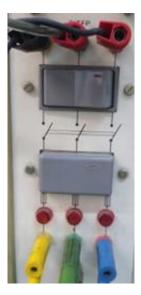
Figura 61: Interruptor trifásico con protección mediante fusibles
