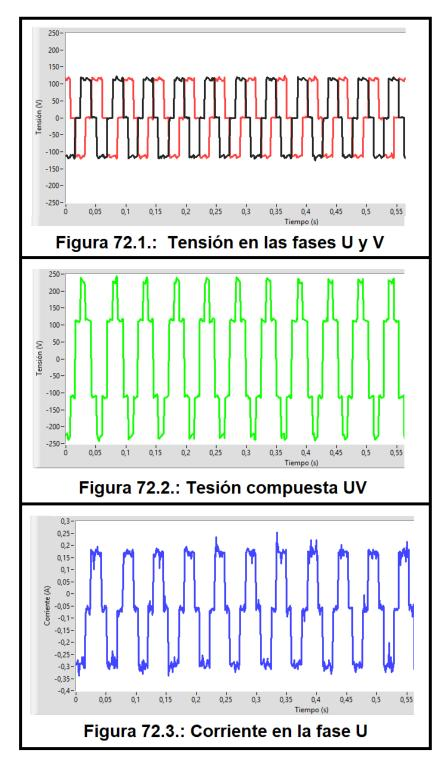
Figura 72: Resultados obtenidos de simular a una frecuencia de conmutación de 120Hz
