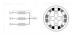
Figura 9: Motor paso a paso de reluctancia variable ([8])
