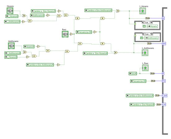
Figura 45: Sistema de bloques que permite seleccionar el sentido de giro del motor paso a paso o detenerlo
