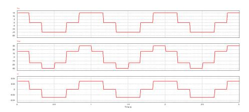
Figura 23: Tensión de fase U, tensión de línea UV y corriente para el circuito de la figura 22
