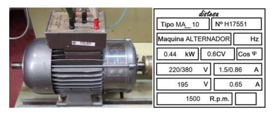
Figura 2: Máquina síncrona. Actúa como motor paso a paso o generador síncrono. A su derecha se puede ver su tabla de características
