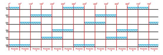
Figura 18: Gráfica en lógica positiva de las señales de control de la tabla 8
