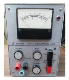
Figura 44: Fuente de alimentación para el circuito de excitación de la máquina síncrona
