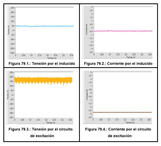
Figura 79: Resultados de la máquina de corriente continua actuando como generador de corriente continua girando a 500 rpm
