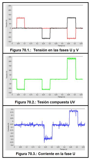
Figura 70: Resultados obtenidos de simular a una frecuencia de conmutación de 10Hz
