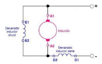
Figura 7: Máquina de corriente continua con sistema de excitación compound de corta derivación ([5] página 30)
