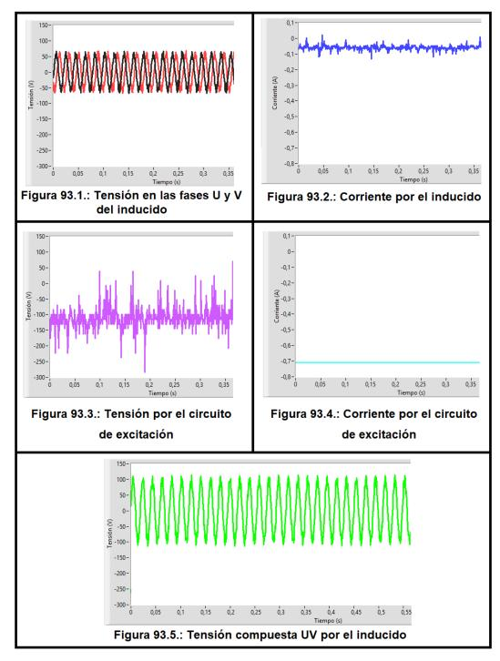
Figura 93: Resultados obtenidos para la máquina síncrona actuando como generador síncrono
