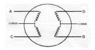
Figura 12: Motor paso a paso unipolar con 6 cables de salida ([8])
