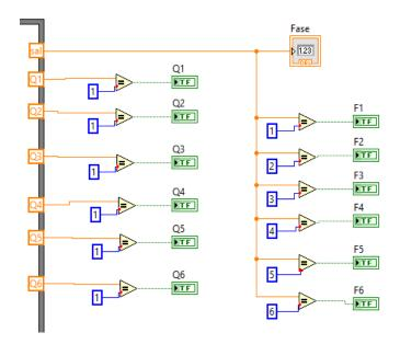
Figura 32: Sistema de bloques que trabajan con las señales de salida de la estructura formula mode
