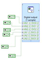
Figura 40: Bloque de salidas digitales que manda las señales de control al circuito integrado
