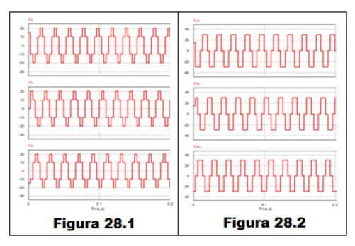
Figura 28: Tensiones de fase y de línea obtenidas de simular en PSIM el circuito de la figura 25 con una tensión de alimentación de 30V y una frecuencia de conmutación de 50Hz
