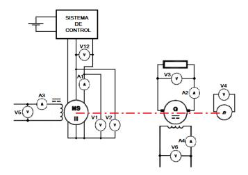
Figura 8: Sistema motor funcionando la máquina síncrona como motor paso a paso
