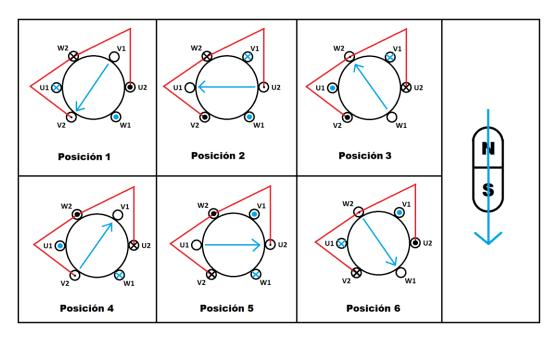
Figura 20: Posiciones del inducido del motor paso a paso (con un par de polos en el inducido)
