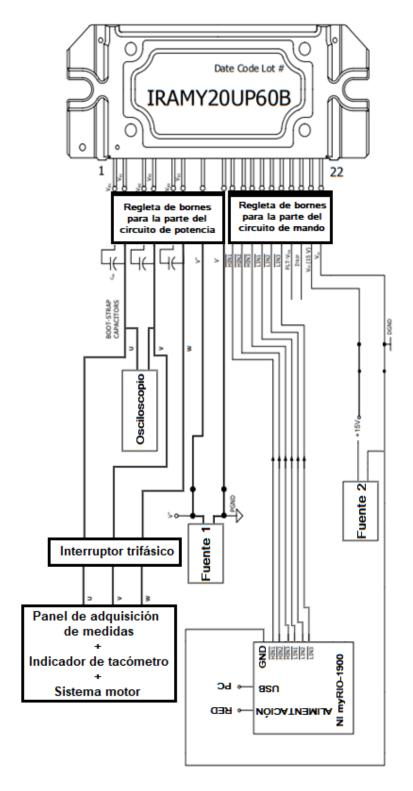
Figura 7: Esquema para la adquisición de datos del sistema de tracción
