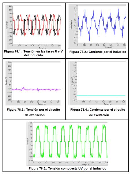
Figura 78: Resultados de la máquina síncrona actuando como motor paso a paso girando a 500 rpm
