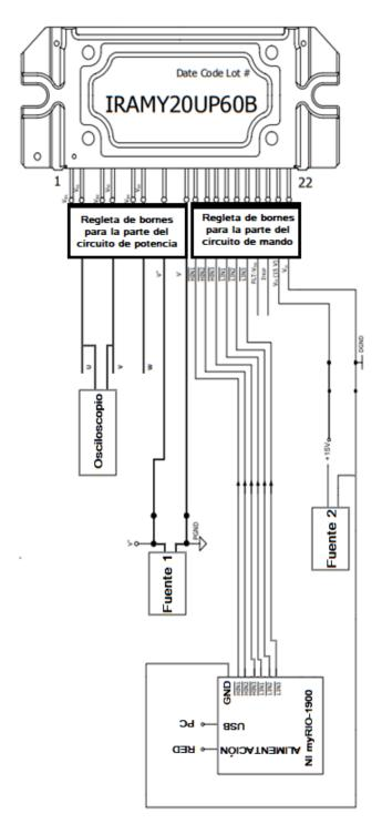
Figura 1: Esquema del circuito físico a montar para la comprobación del correcto funcionamiento del programa de control básico
