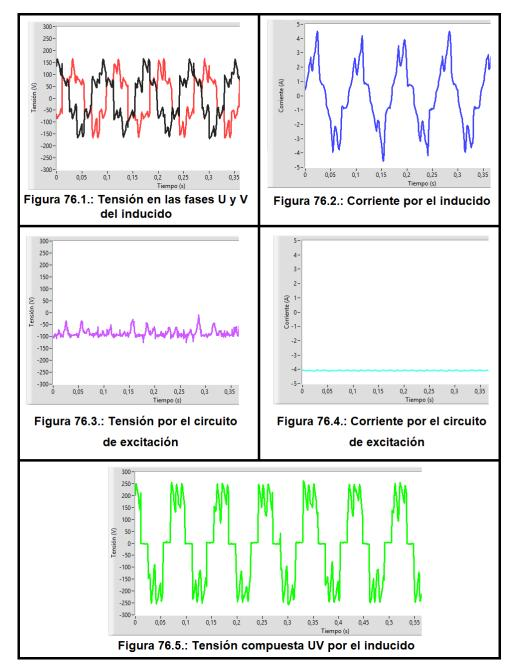
Figura 76: Resultados de la máquina síncrona actuando como motor paso a paso girando a 350 rpm
