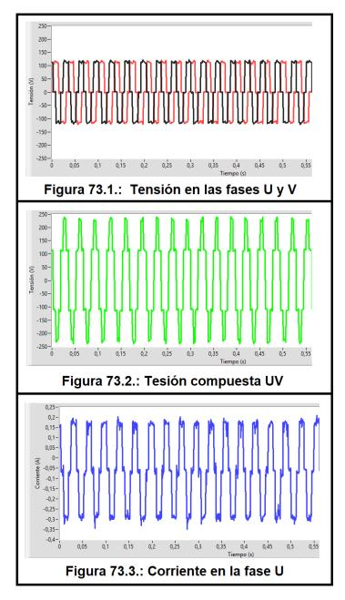
Figura 73: Resultados obtenidos de simular a una frecuencia de conmutación de 200Hz
