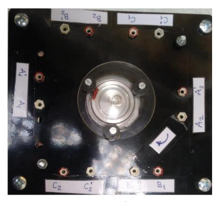
Figura 1: Alternador de 5V, en este TFG se hará funcionar como motor paso a paso
