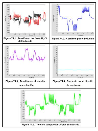
Figura 74: Resultados de la máquina síncrona actuando como motor paso a paso girando a 100 rpm
