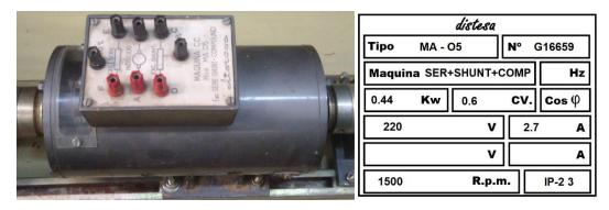
Figura 3: Máquina de corriente continua. Actúa como motor o generador de corriente continua. A su derecha se encuentra su tabla de características
