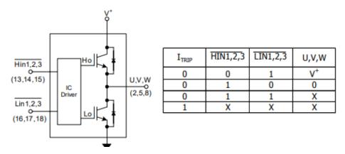
Tabla 6: Tabla de niveles lógicos de las señales de entrada y salida para los seis canales del inversor trifásico del IRAMY20UP60B ([13] página 6)
