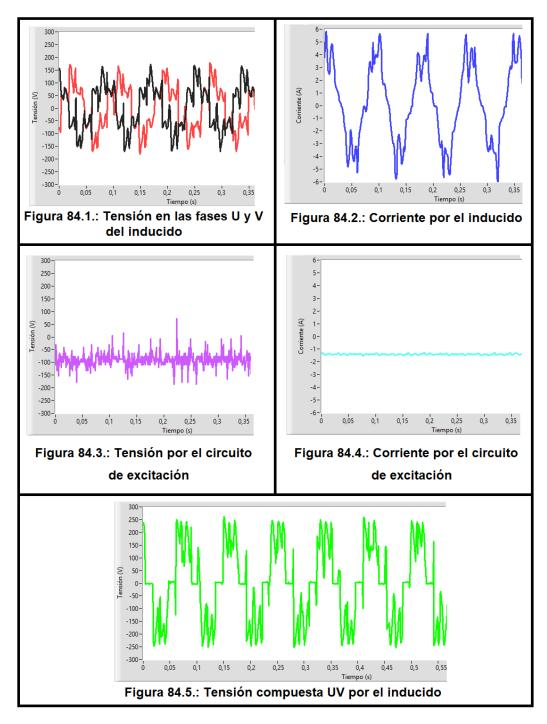
Figura 84: Resultados de la máquina síncrona actuando como motor paso a paso girando a 350 rpm con su circuito de excitación cortocircuitado
