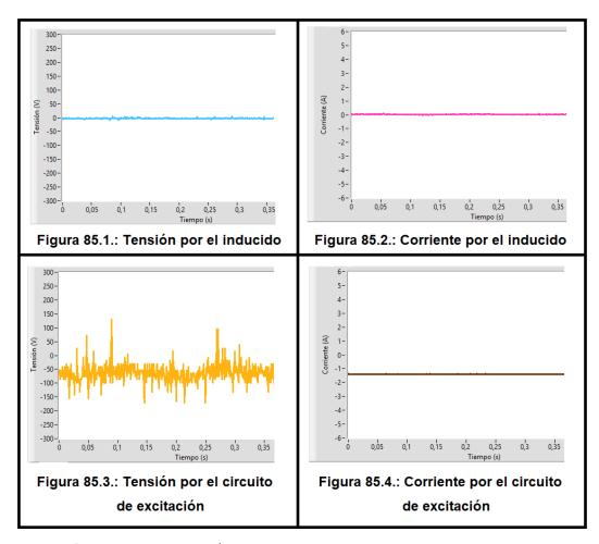
Figura 85: Resultados de la máquina de corriente continua actuando como generador de corriente continua girando a 350 rpm con su circuito de excitación cortocircuitado
