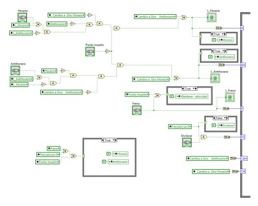
Figura 53: Sistema de bloques que permite la selección del sentido de giro, enclavamiento o freno del motor paso a paso
