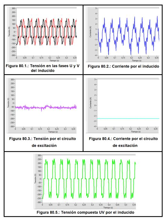
Figura 80: Resultados de la máquina síncrona actuando como motor paso a paso girando a 750 rpm
