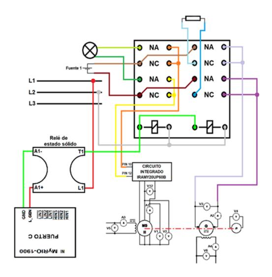
Figura 11: Esquema del sistema motor, contactores y relé de estado sólido para el circuito de la figura 10
