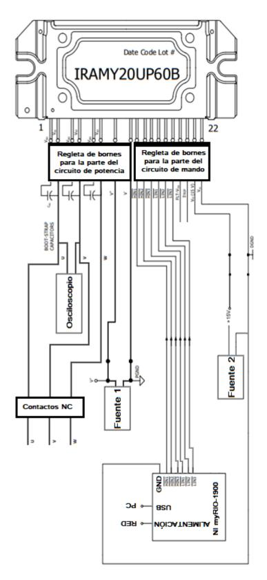
Figura 5: Esquema del circuito base para la obtención de los valores experimentales
