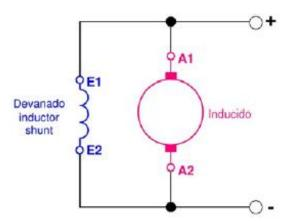
Figura 5: Máquina de corriente continua con sistema de excitación derivación o shunt ([5] página 30)
