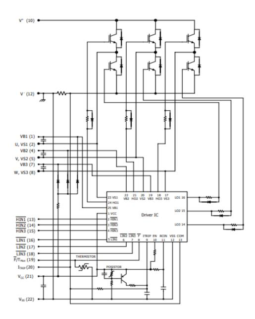
Figura 1: Esquema eléctrico interno del circuito integrado ([14] página 2)
