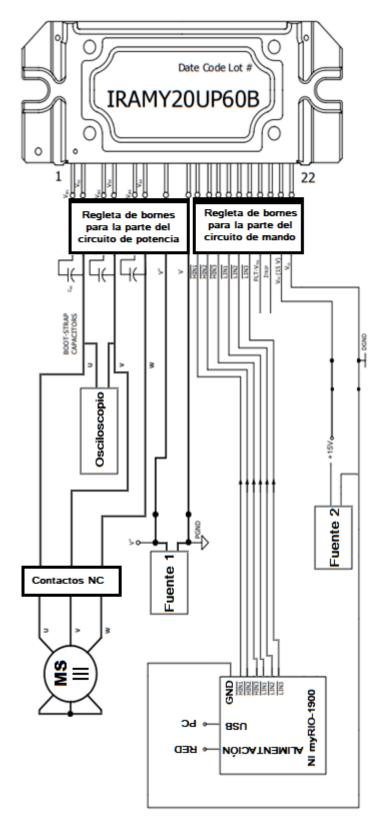
Figura 4: Esquema del circuito resultante de sustituir el alternador de la figura 3 de este anexo por una máquina síncrona
