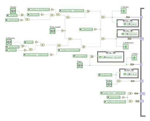
Figura 88: Sistema de bloques que permite la selección del sentido de giro, enclavamiento o freno del motor paso a paso
