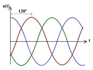
Figura 86: Onda sinusoidal trifásica ([15])
