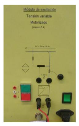
Figura 59: Fuente 1. Autotransformador, produce hasta 315V y 3A de corriente continua
