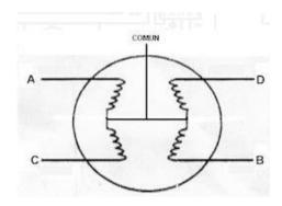
Figura 11: Motor paso a paso unipolar con 5 cables de salida ([8])
