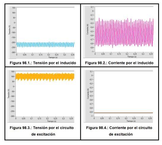
Figura 98: Resultados obtenidos para la máquina de corriente continua actuando como motor con una tensión de excitación de 170V
