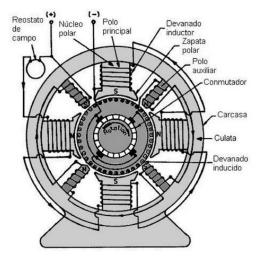
Figura 3: Esquema de un generador de corriente continua ([5] página 9)
