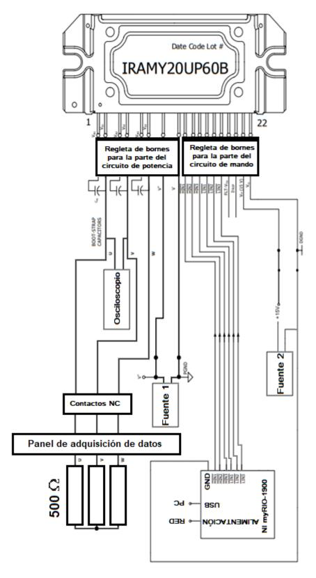
Figura 6: Esquema para la adquisición de datos con carga resistiva
