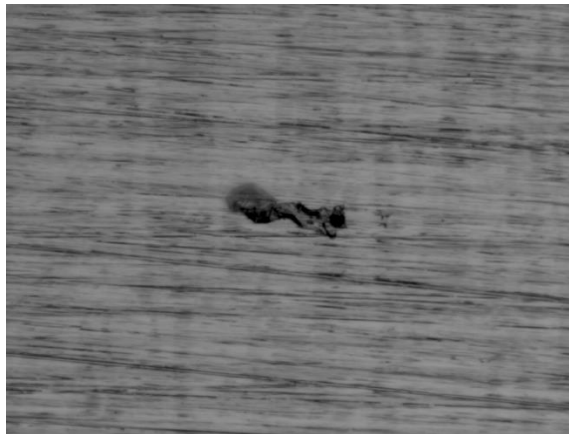
Figura 30. Micrografía a 100x del acero 2205 para una duración de ensayo de 60 minutos.
