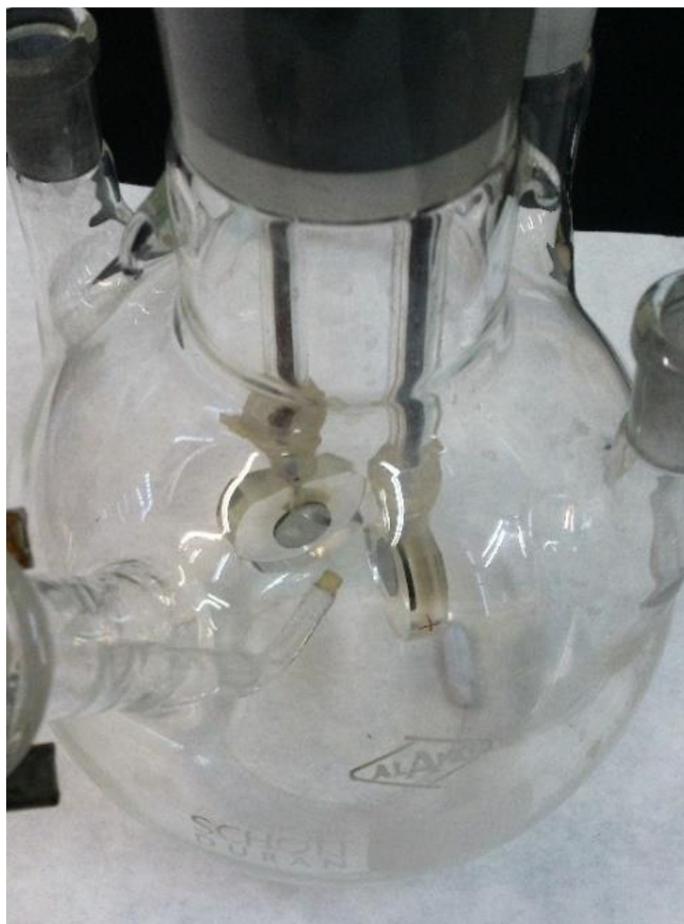
Figura 15. Montaje de las probetas y electrodo de referencia en el matraz.
