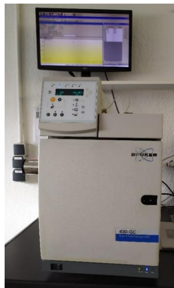
Figura 3.5.1-1 Cromatógrafo de gases con detecto de conductividad térmica Bruker 430 GC
